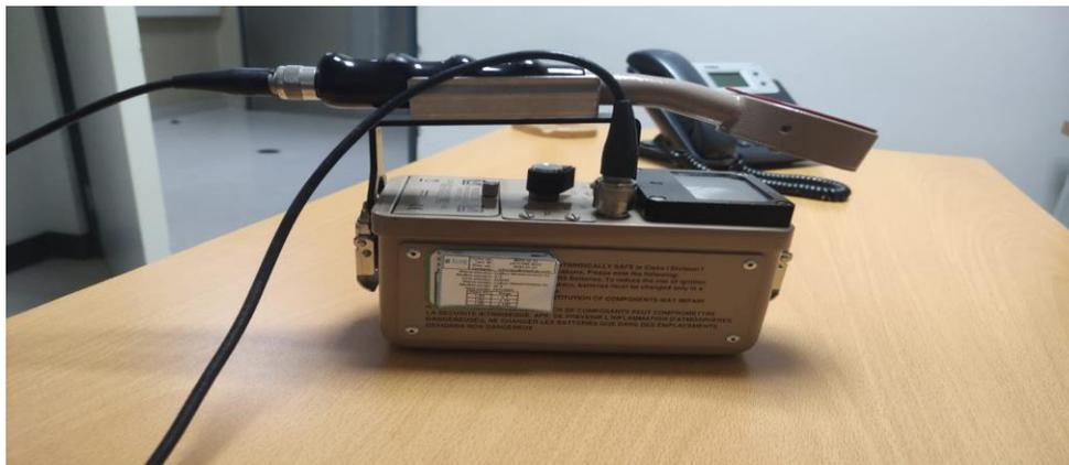
Figura 7. Detector de radiaciones portátil con sonda de contaminación.
