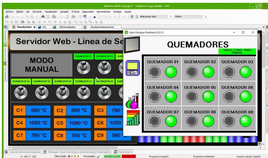
En la Figura 30 se muestra el monitoreo de la curva de calor durante el proceso de cocción de los ladrillos de forma local desde la HMI (izquierda) y remota desde el servidor web (derecha).
