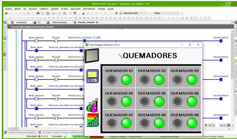
En la Figura 29 se muestra la operación manual de cada quemador de forma independiente activado remotamente desde el servidor web (izquierda) y de la HMI (derecha) como control en modo local.
