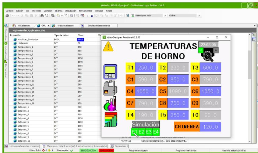
En la Figura 27 se muestra la pantalla del HMI (derecha) que monitorea de forma local las temperaturas en el horno tipo túnel y la sección del servidor web (izquierda) que monitorea de forma remota las temperaturas.
