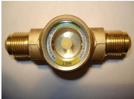
*Nota:* Si el visor se encuentra burbujeando es un indicador que falta refrigerante o regular la válvula de expansión termostática.
