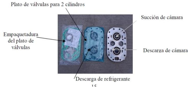
*Nota:* Partes de los platos de válvula de succión y descarga de un compresor.
