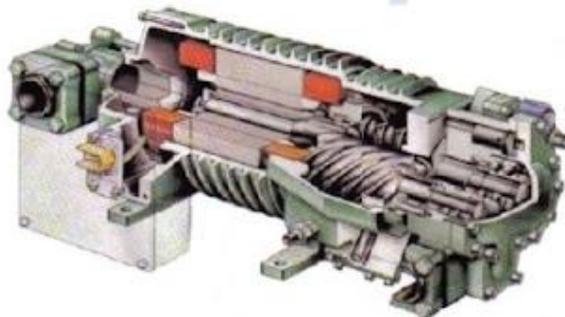
*Nota:* En la figuramos observamos la parte interna de un compresor tornillo.
