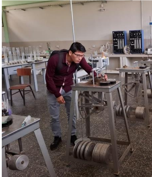
Foto Ensayo Consolidación Unidimensional
