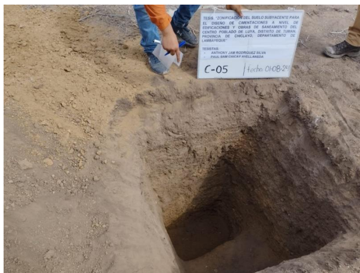
Foto N°4: Identificación de estratos de calicata 5.
