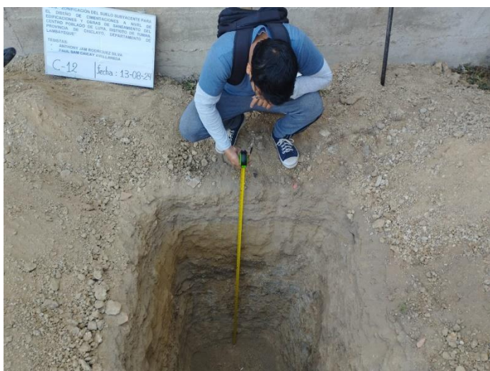
Foto N°6: Identificación de estratos de calicata 12.
