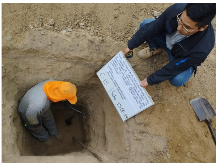
Foto N°7: Uso de posteadora en calicata 15.
