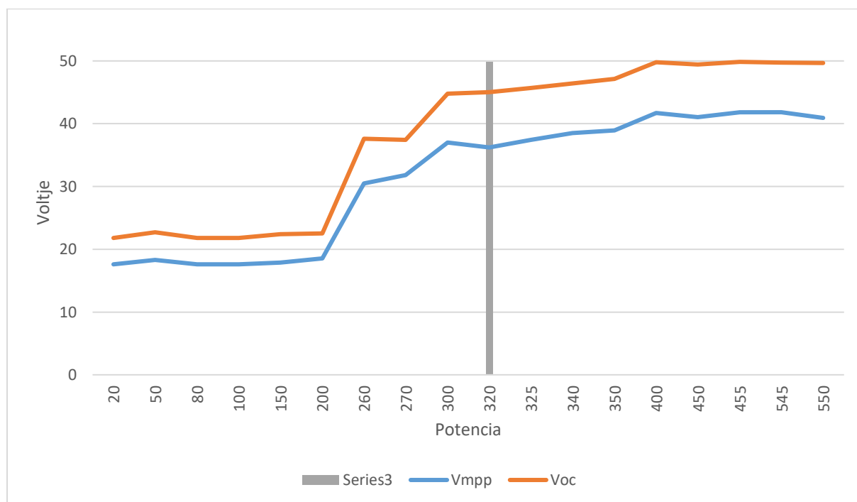
Figura 9. Voltaje a potencia máxima V_{mpp} y circuito abierto V_{oc} según potencia de paneles
