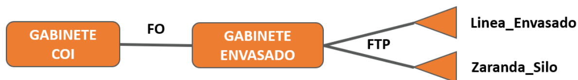
Figura 54. Diagrama de conexión entre cámaras de Envasado con gabinete y el COI
