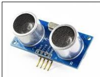
Sensor Ultrasónico HC-SR04
