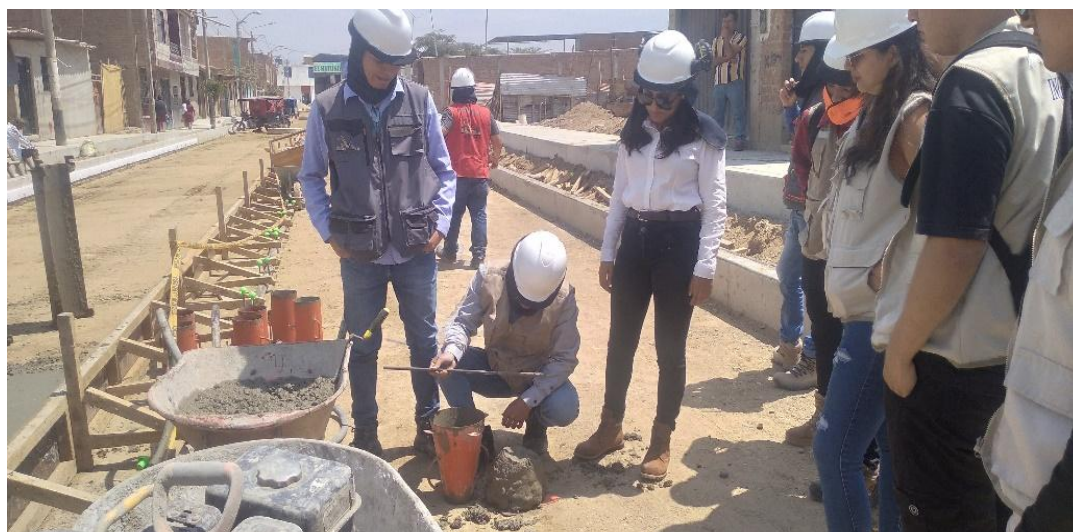
Fotografía 22: REALIZACIÓN DE LA PRUEBA DE ASENTAMIENTO PARA CONCRETO DE PAVIMENTO
