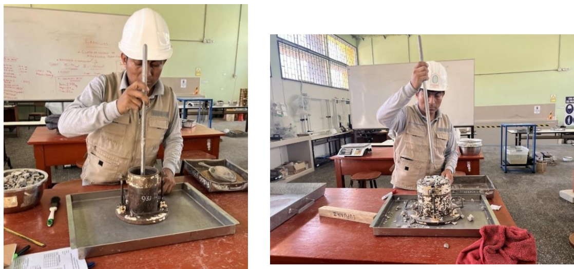
Figura 07: Realización de ensayo de peso volumétrico varillado del A. Fino y A. Grueso en el laboratorio de ensayos y materiales- FICSA- UNPRG
