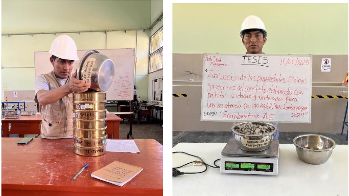
Figura 03: Realización de ensayo de análisis granulométrico para agregado grueso-concreto reciclado en el laboratorio de ensayos y materiales- FICSA- UNPRG
