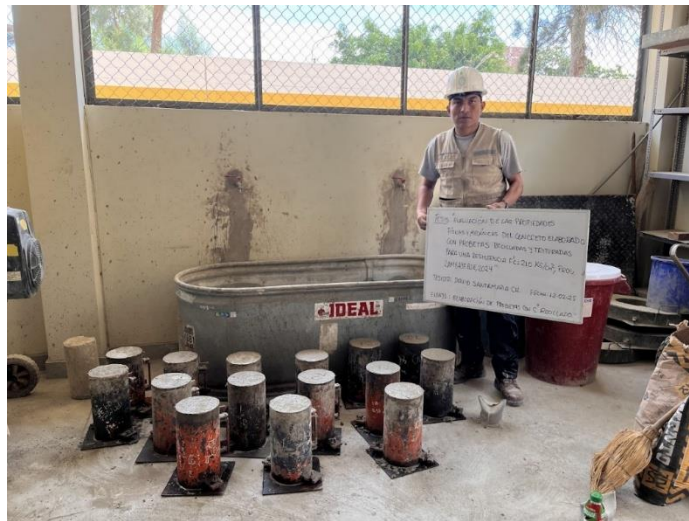
Figura 08: Realización de probetas de concreto para pruebas de compresión y tracción indirecta
