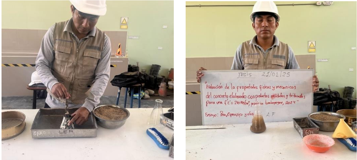
Figura 04: Realización de ensayo de peso específico de masa y absorción del agregado fino en el laboratorio de ensayos y materiales- FICSA- UNPRG
