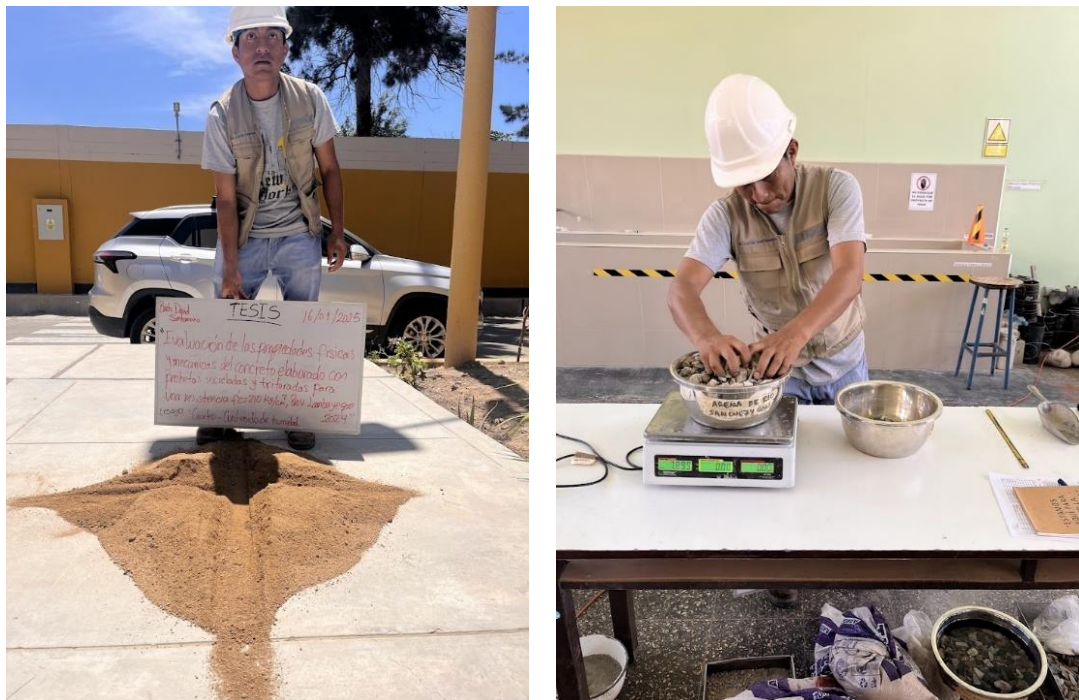
Figura 01: Realización de ensayo de contenido de humedad en el laboratorio de ensayos y materiales- FICSA- UNPRG
