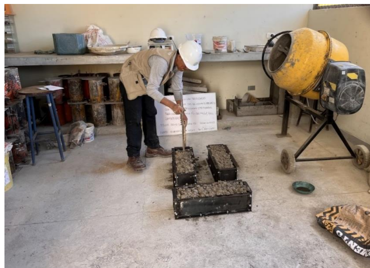
Figura 09: Realización de vigas de concreto para pruebas de flexión
