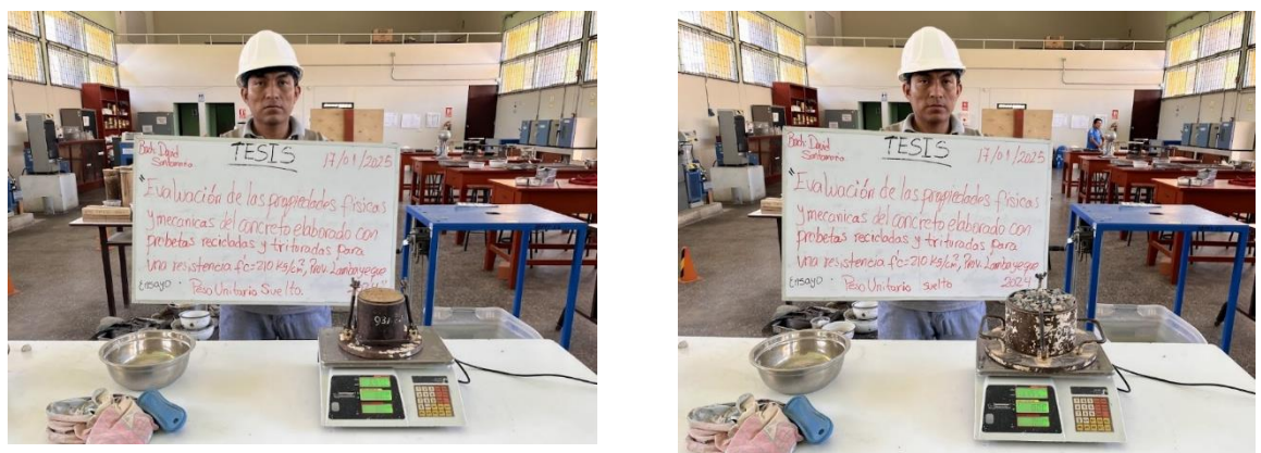
Figura 06: Realización de ensayo de peso volumétrico suelto del agregado fino y grueso en el laboratorio de ensayos y materiales- FICSA- UNPRG
