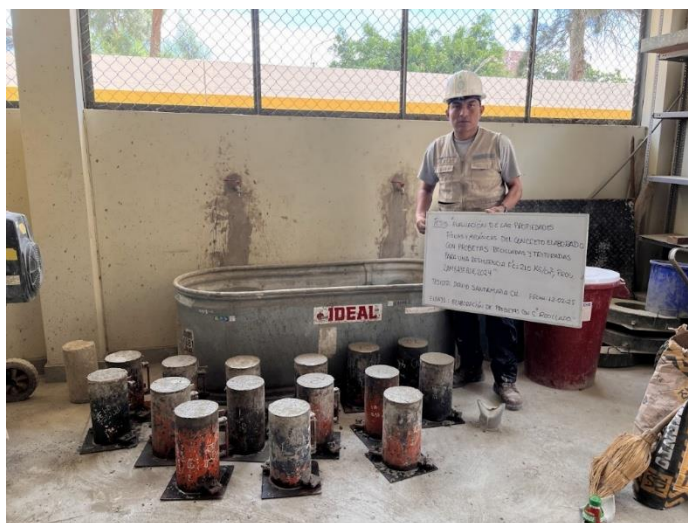
Figura 08: Realización de probetas de concreto para pruebas de compresión y tracción indirecta
