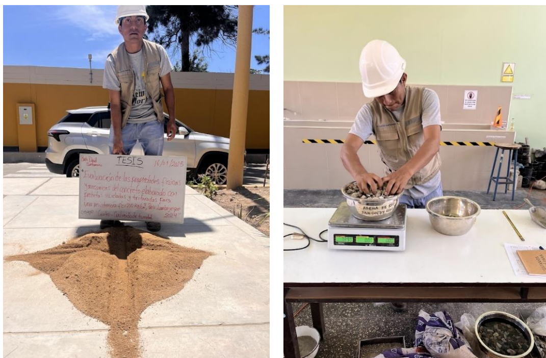
Figura 01: Realización de ensayo de contenido de humedad en el laboratorio de ensayos y materiales- FICSA- UNPRG
