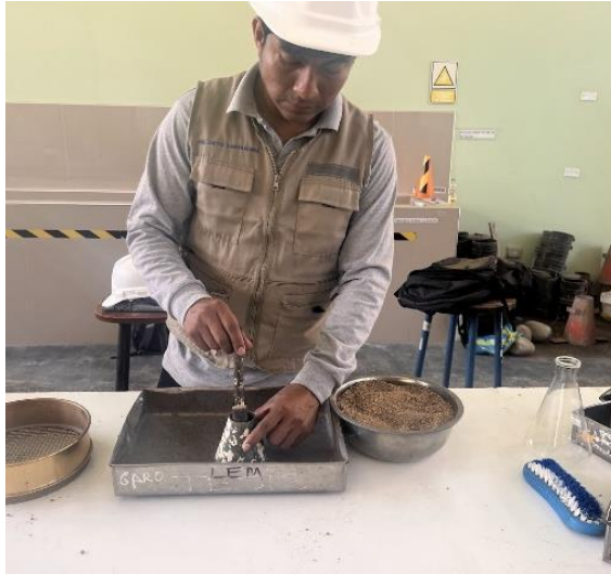
Figura 04: Realización de ensayo de peso específico de masa y absorción del agregado fino en el laboratorio de ensayos y materiales- FICSA- UNPRG
