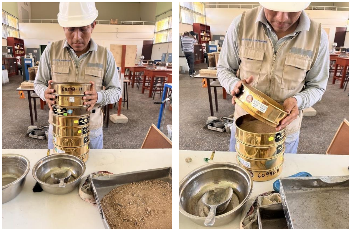
Figura 02: Realización de ensayo de análisis granulométrico para agregado fino en el laboratorio de ensayos y materiales- FICSA- UNPRG
