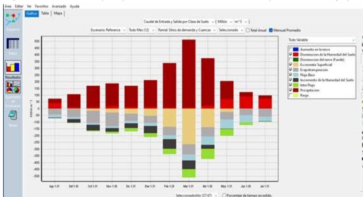
Figura 19. Balance de precipitación escurrentía en la cuenca (modelo hidrología)
