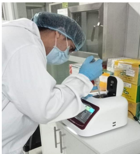
Imagen 10: Cuantificación de ADN extraído mediante el UV/ Vis Nabi
