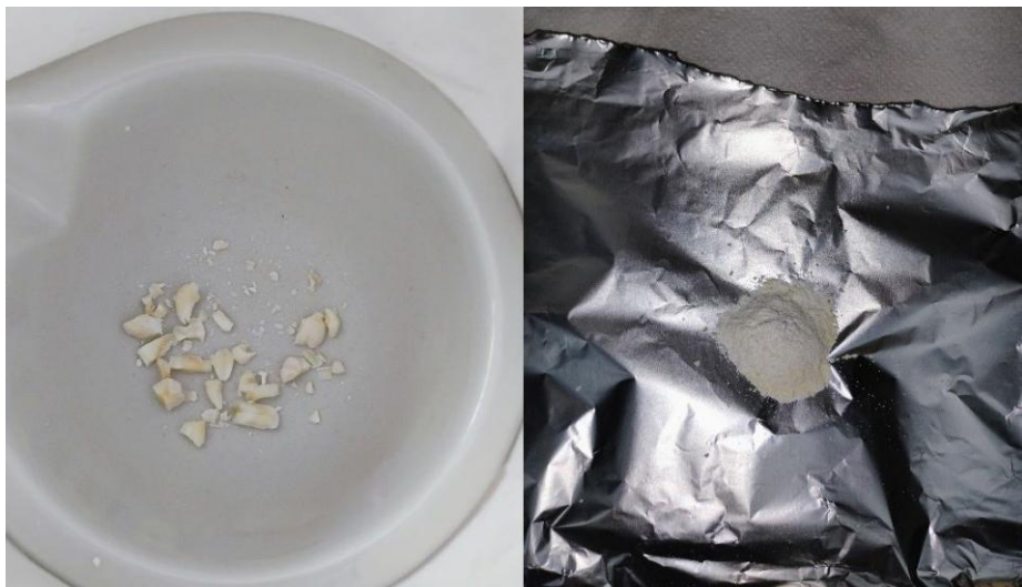
Imagen 4: Criogenización y pulverización de las muestras dentarias
