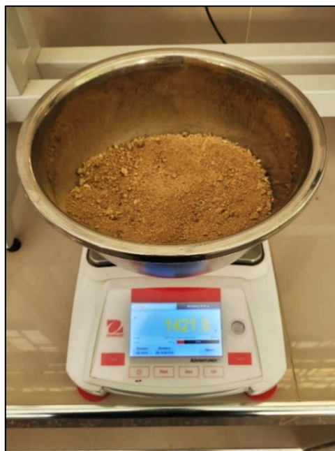
Figura 22 Peso de cada retenido de agregado fino.
