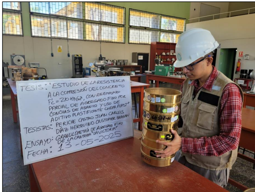
Figura 21 Tamizado del agregado fino.
