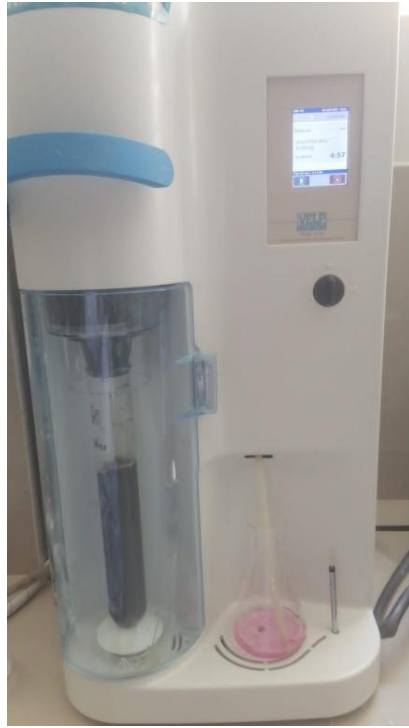
Imagen 43 Destilación de muestra 7
