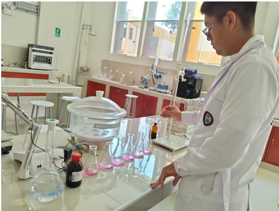
Imagen 36 preparación de ácido bórico más indicador de Tashiro para entrar al proceso de destilación
