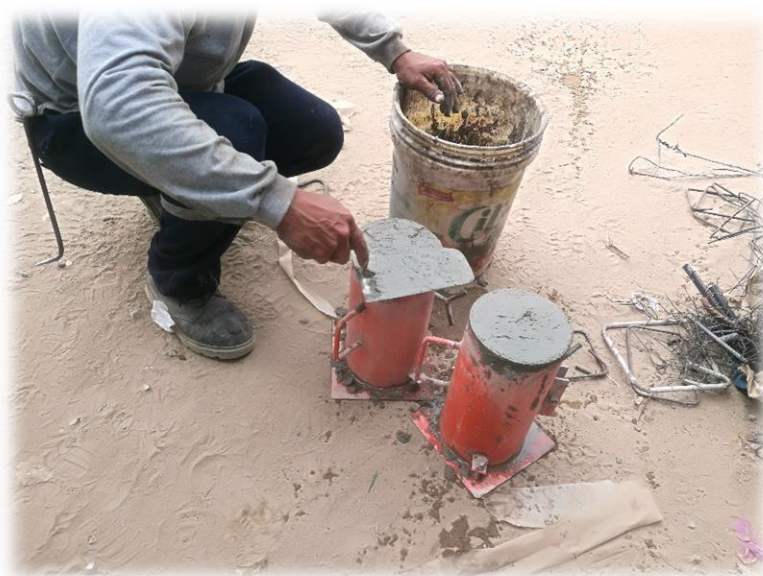
Imagen 28: Proceso de obtención de muestra para elaboración de probeta de concreto
