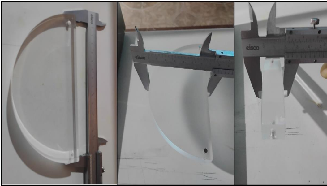
Figura 18: Lente planoconvexo, materializada de acrílico con índice de refracción de 1.49, longitud de 144 mm, verificados con un vernier.
