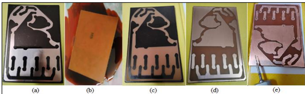
Figura 24: (a) Circuito dibujado en la baquelita; (b) Grabado artesanal del circuito; (c) Circuito grabado artesanalmente; (d) Circuito limpio; (e) Perforaciones en el circuito.
