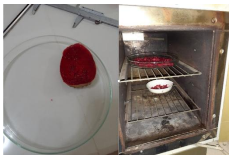
Figura 17. Determinación de humedad Nota. Elaboración Propia (2022)
