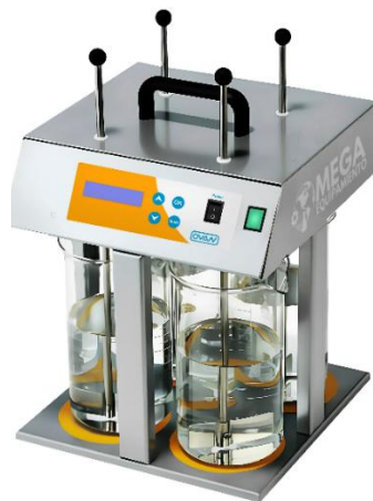
Figura 2. Floculador portátil para prueba de jarras.
