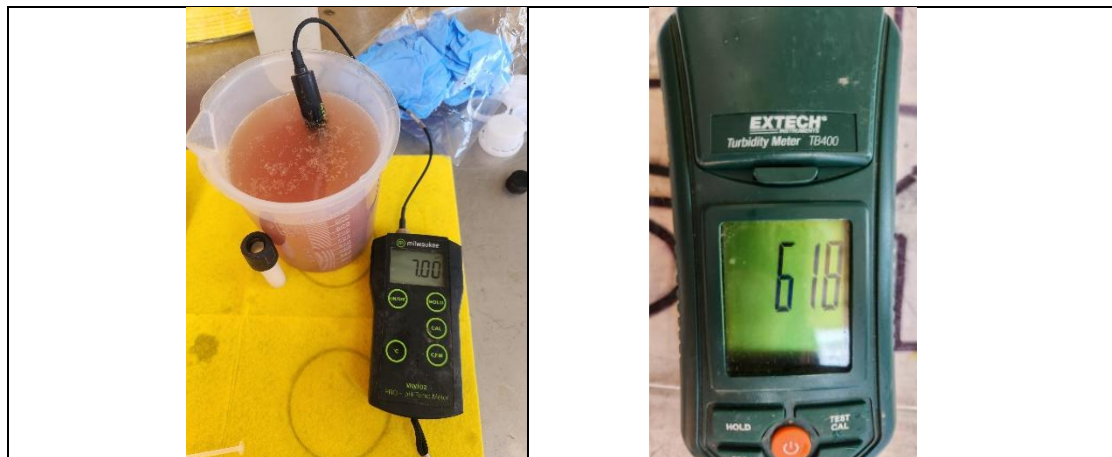
Figura 16. Lectura de pH y turbidez del afluente
