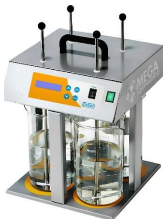
Figura 2. Floculador portátil para prueba de jarras.
