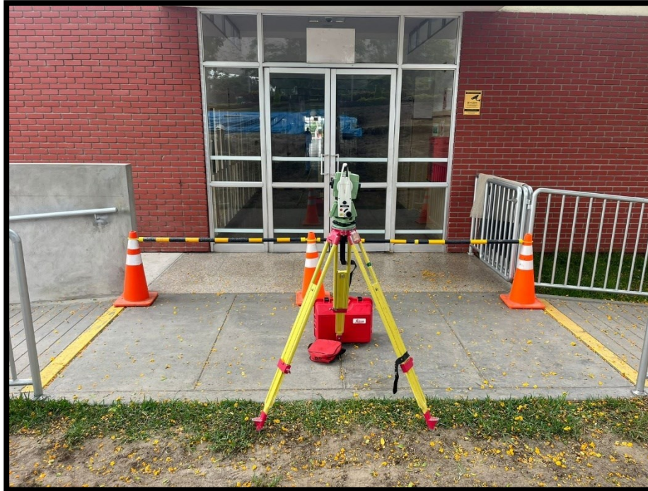
Fotografía 9 Estación total para levantamiento topográfico
