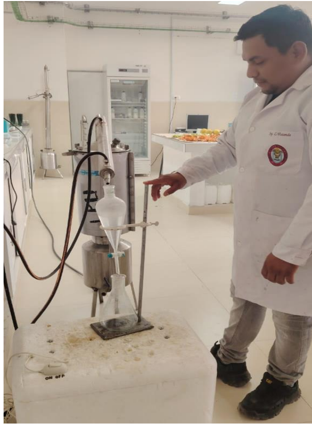
Figura 10: Obtención del extracto oleoso por sistema de arrastre por vapor
