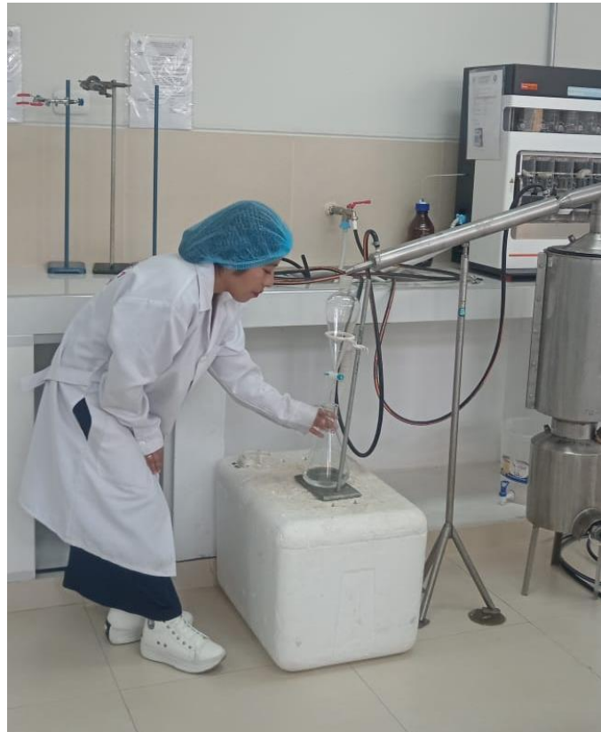
Figura 2: Equipo de extracción por arrastre por vapor
