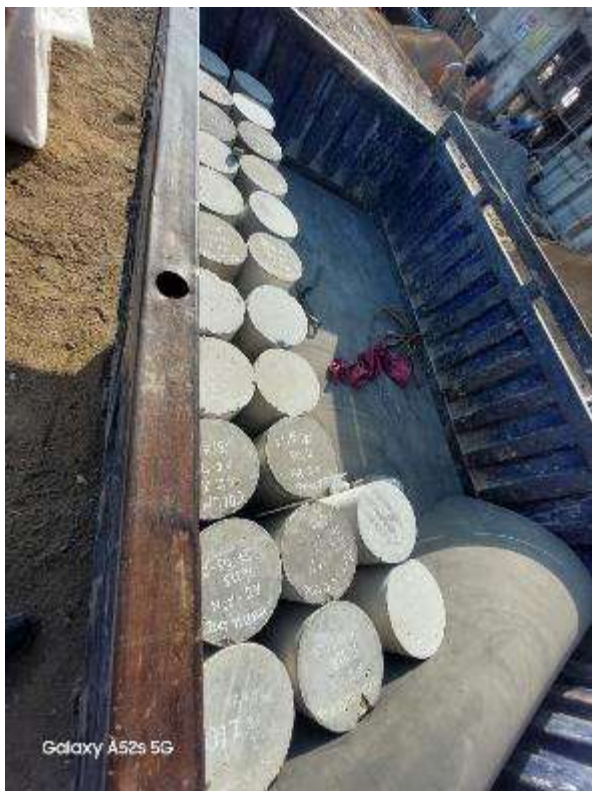
Figura 231: Probetas en traslado al laboratorio para los ensayos respectivos.
