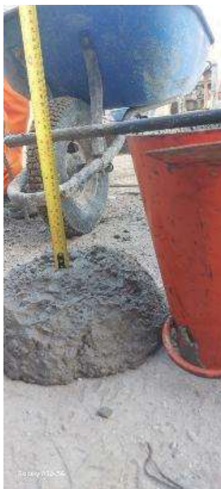
Figura 230: Ensayo de cono de Abrams.
