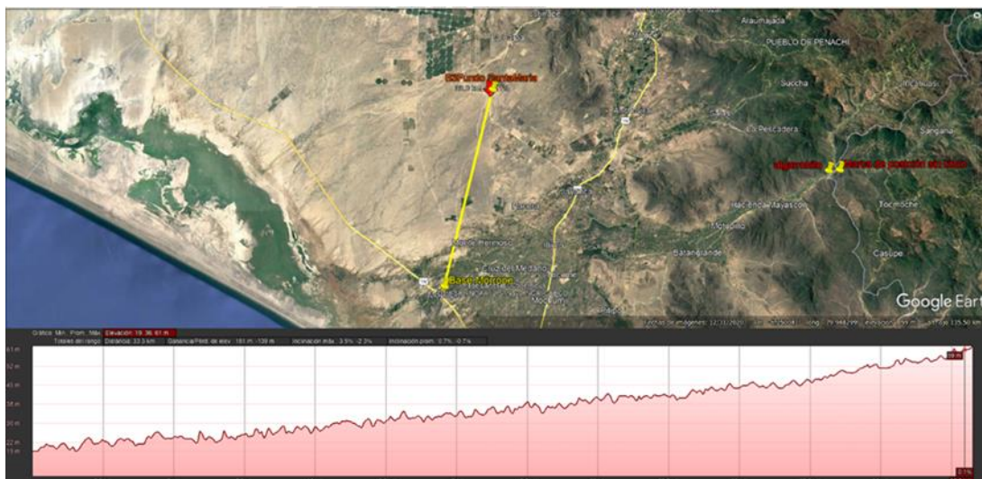
Figura 4: Perfil del enlace PTP, Base Mórrope – Remoto caserío Pañalá
