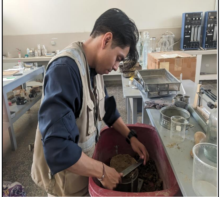
Ensayo Proctor Modificado: Enrasado de material en molde luego de la compactación FOTO 46
