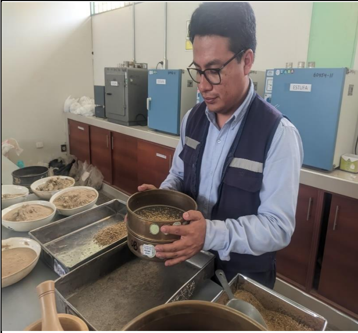
Ensayo Granulometría (Procedimiento): Tamizado de material de afirmado
