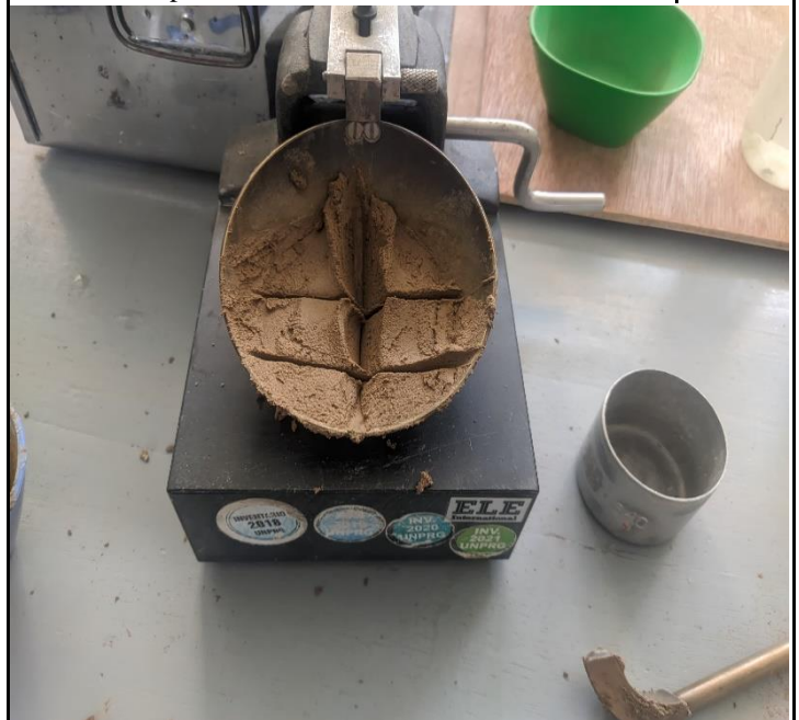
Ensayo Limite Liquido - procedimiento: luego del golpeo en la copa de casagrande
