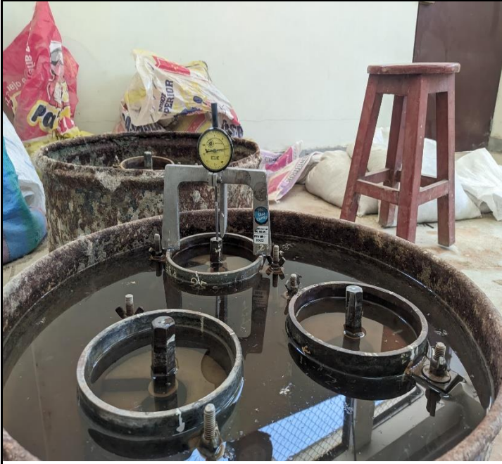
Ensayo CBR: Lectura de la deformación con el dial de presión
