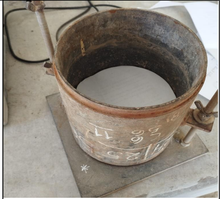
Ensayo CBR: Papel filtro colocado luego de voltear el molde cumpliendo la función de separar
