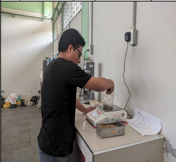
Ensayo Contenido de humedad - procedimiento: Pesado de muestra de afirmado (material de cantera) antes de colocar al horno
