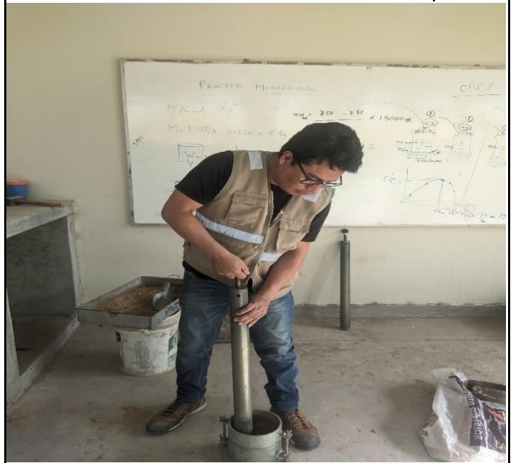
Ensayo CBR: Compactación con pison, para 56 golpes por capa
