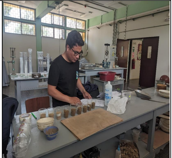
Ensayo Sales Totales: Muestras de material de cantera (afirmado)
