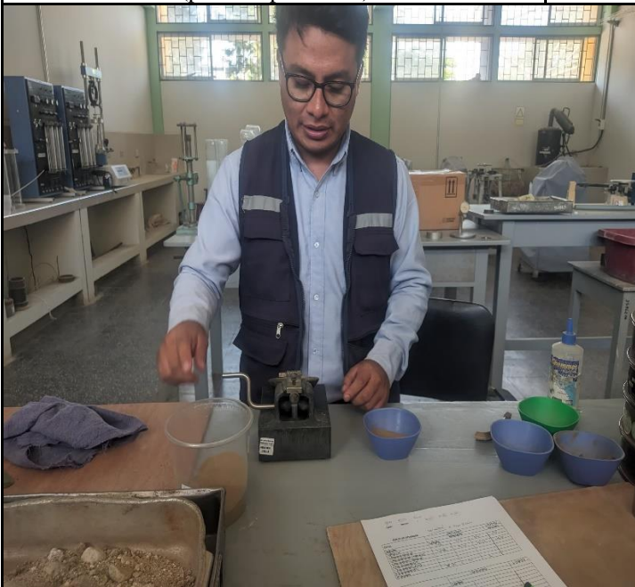
Ensayo Limite Liquido - procedimiento: Golpeo con la copa de Casagrande FOTO 39
