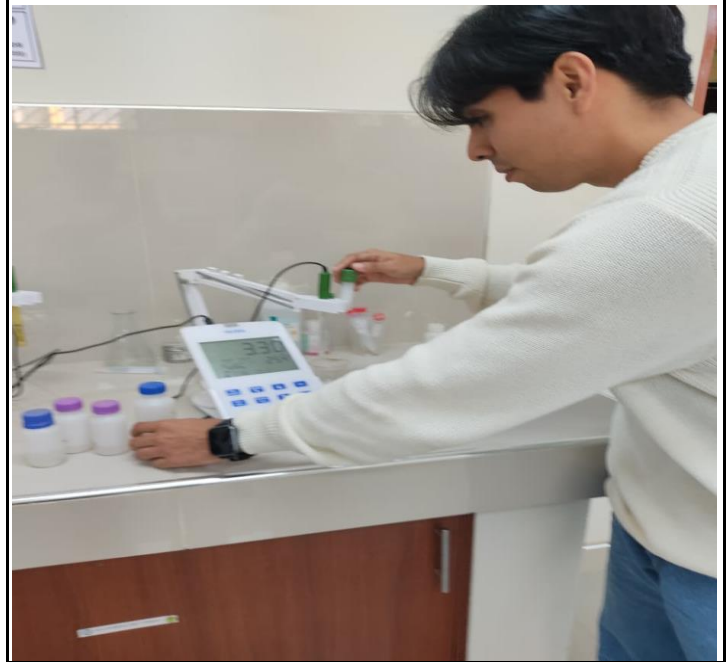
Foto 2: Conductivimetro utilizado para determinar la salinidad de las muestras.*
