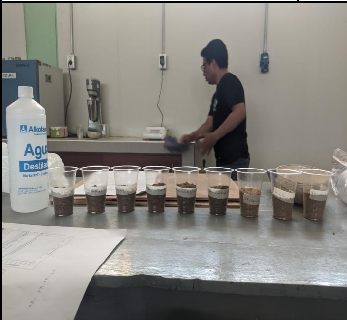
Ensayo Sales Totales: Muestras de las tres canteras utilizadas con las combinaciones de agua de mar
