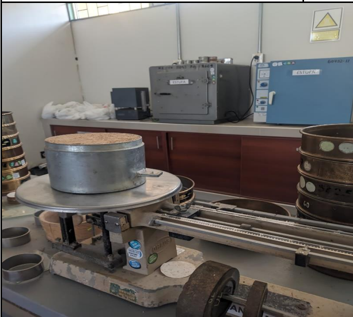
Ensayo Proctor Modificado: Pesado de muestra compactada, más el molde FOTO 47
