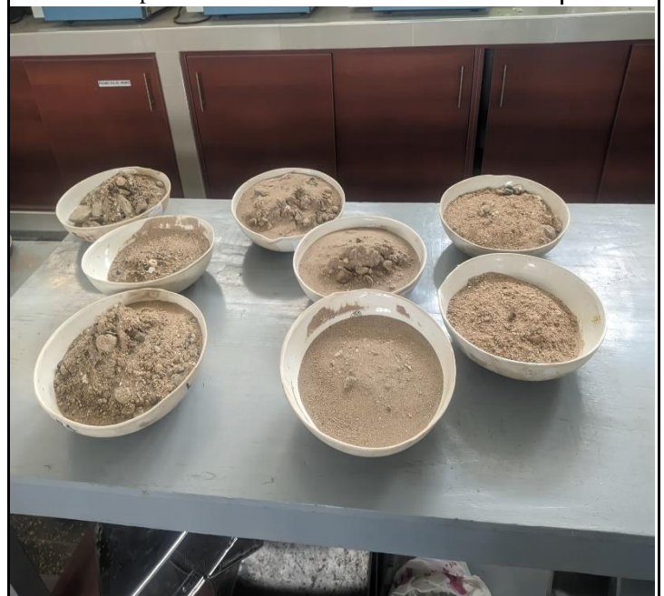
Ensayo Granulometría (Procedimiento): Muestras secas de las tres canteras (material de afirmado)
