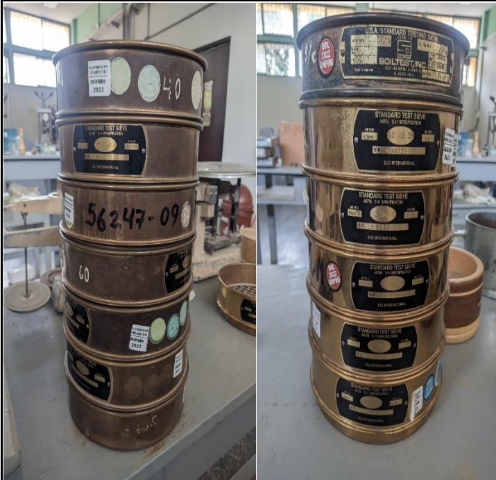
Tamices utilizados para realizar los ensayos en el laboratorio de mecánica de suelos de la facultad-FICSA
