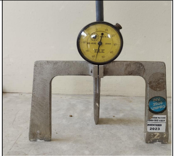
Ensayo CBR: Dial utilizado para medir la deformación en cada día que pasa inmersa la muestra
