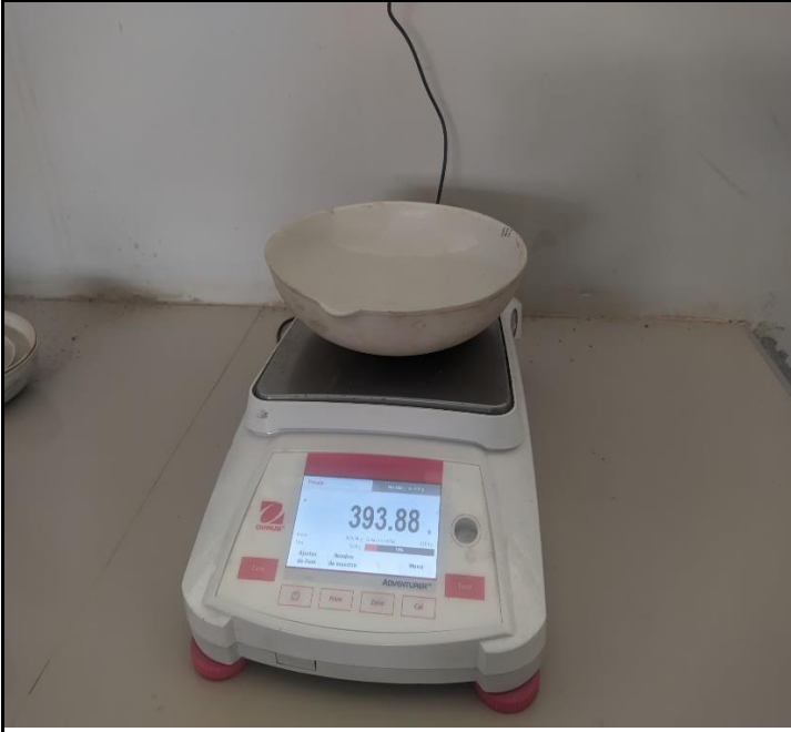
Ensayo Granulometría (Procedimiento): Pesado de tara (plato de porcelana) FOTO 37
