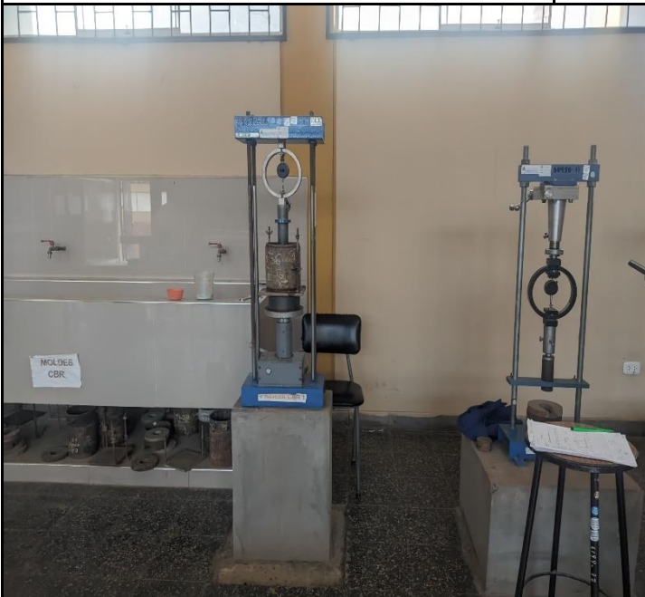
Ensayo CBR: Muestra colocada en la prensa de penetración
