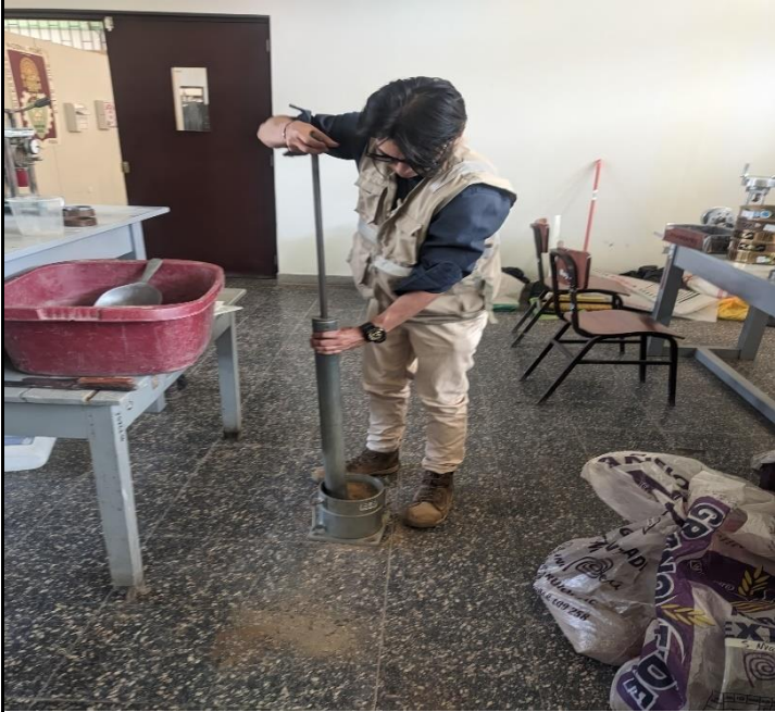
Ensayo Proctor Modificado: Compactación de capa en el molde FOTO 45
