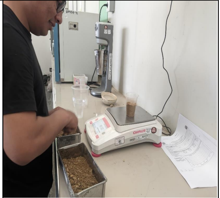
Ensayo Sales Totales: Pesado de la cantidad de muestra seca para realizar el ensayo FOTO 54
