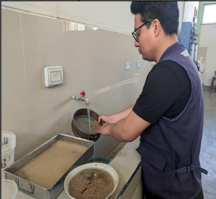
Lavado del material de cantera (afirmado) para la eliminación de finos
