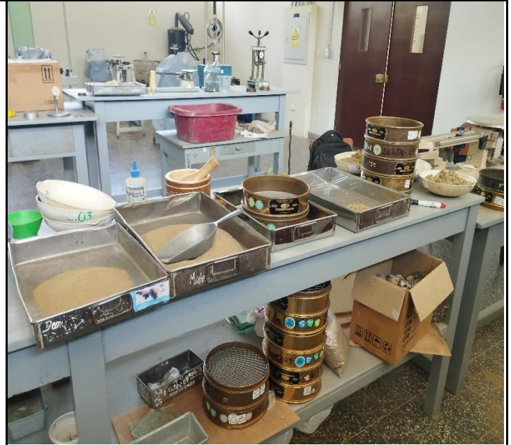
Ensayo Granulometría: Muestras de material de afirmado tamizadas por N° de Tamiz
