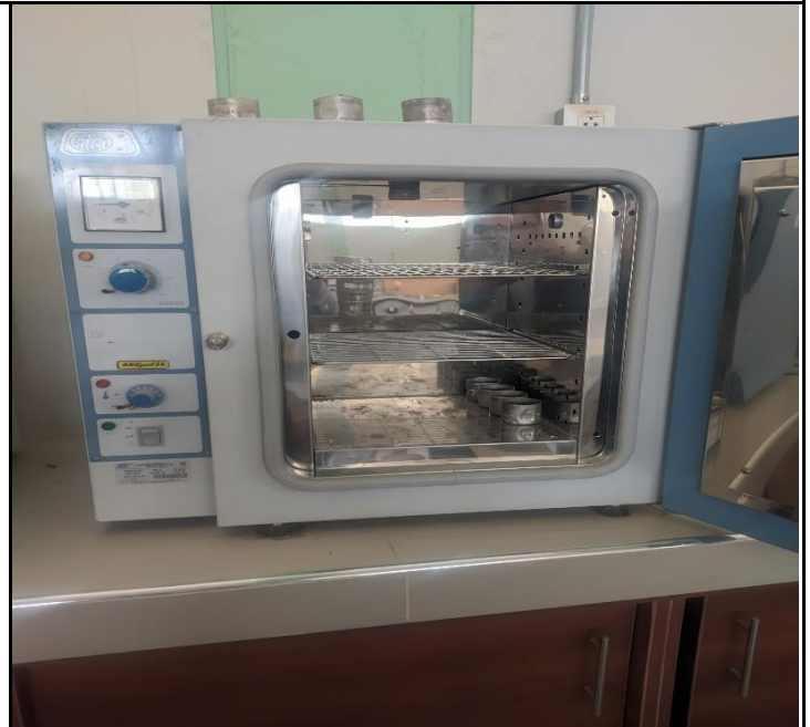
Ensayo CBR: Muestras colocadas al horno para contenido de humedad
