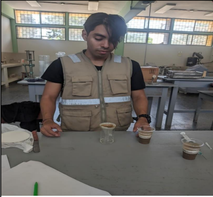
Ensayo Sales Totales: Muestra de afirmado+ agua de mar de playa de Pimentel filtrándose
