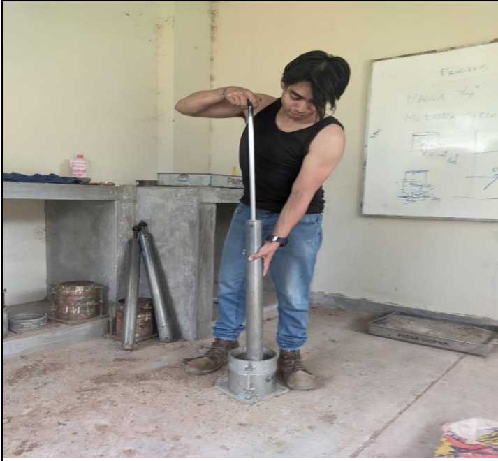
Ensayo CBR: Compactación con el pison a 25 golpes por capa FOTO 69
