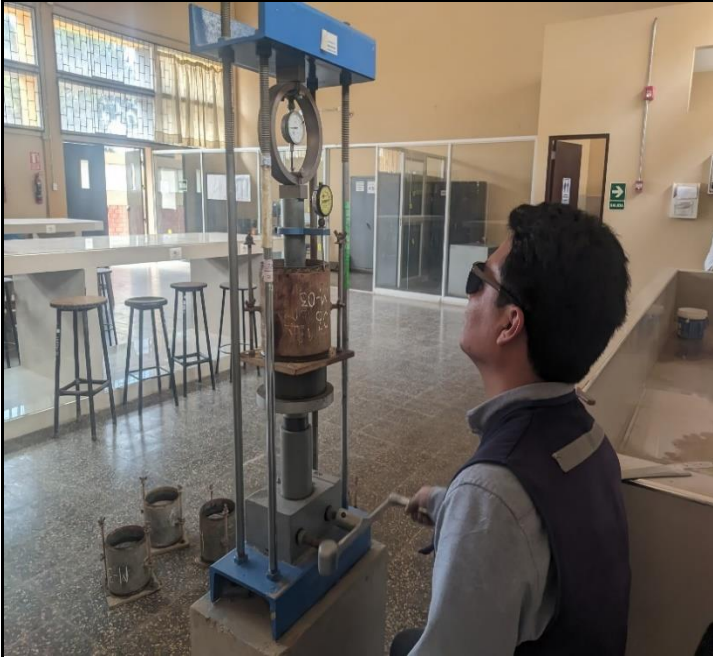
Ensayo CBR: Lectura de penetración en la prensa para los diferentes moldes de acuerdo a la combinación de agua de mar y el material de cantera
