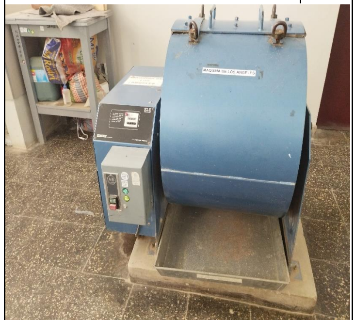
Máquina de Los Ángeles para realizar el ensayo de Abrasión
