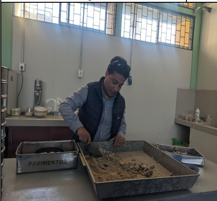
Ensayo de Abrasión: Preparación de muestra antes de entrar a la máquina de Los Ángeles
