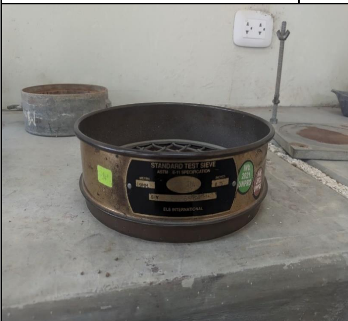
Tamiz N°:3/4" utilizada para el ensayo CBR – Por donde pasa la muestra de afirmado (material de cantera)
