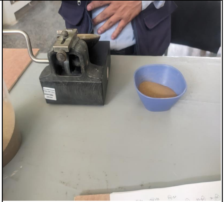
Ensayo Limite Liquido - procedimiento: Mezcla homogénea y uniforme en la copa de Casagrande FOTO 38
