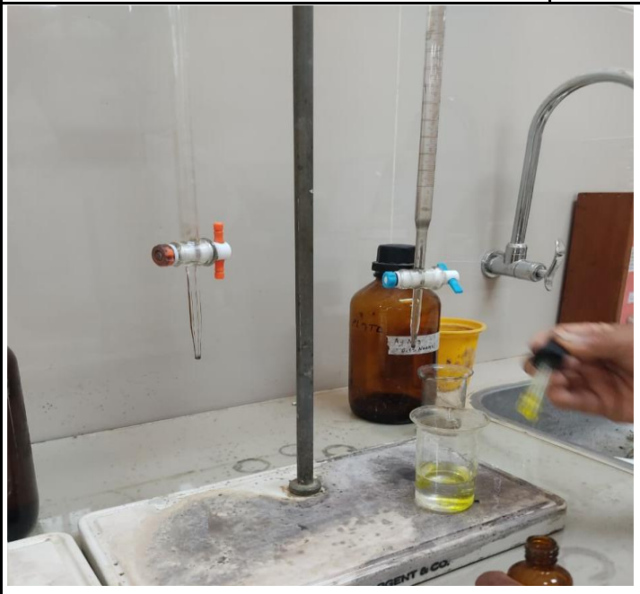
Foto 3: Bureta para metodo de titulacion para ensayo de cloruros.*
