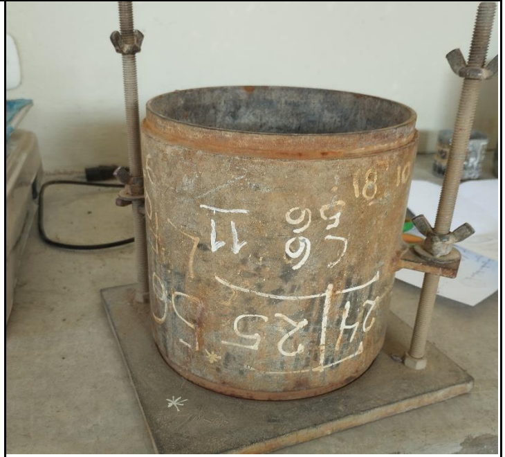
Ensayo CBR: Molde utilizado de 6" para el ensayo
