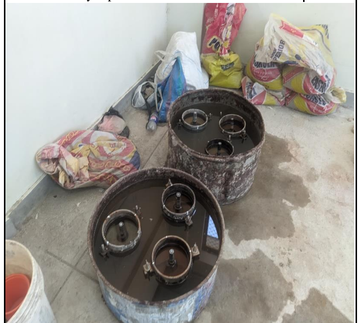
Ensayo CBR - procedimiento: Moldes compactados sumergidos en el agua por 4 días FOTO 72
