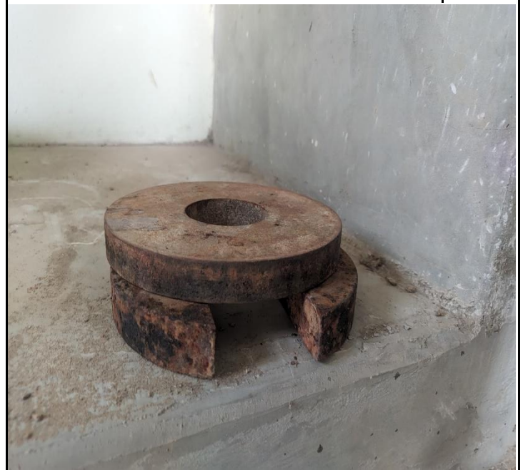
Ensayo CBR: Pesas, colocadas sobre el molde y el vástago para simular la presión real
