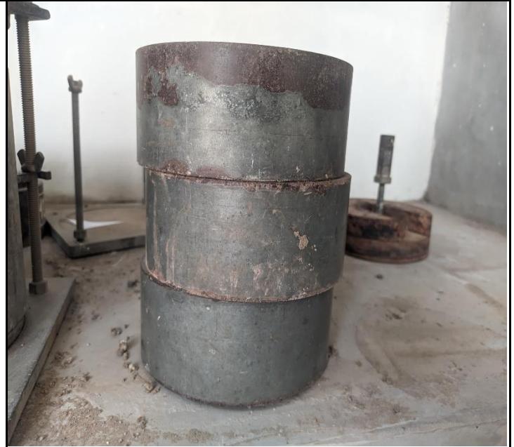
Ensayo CBR: Pesas utilizadas para brindar estabilidad y soporte al molde FOTO 70
