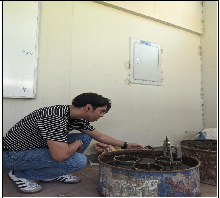
Ensayo CBR: Lectura de deformación con el dial de presión en el día 2
