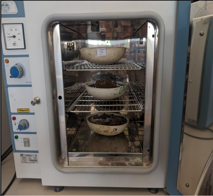
Ensayo Granulometría: Colocación de las muestras en el horno para ser secadas por 24 horas
