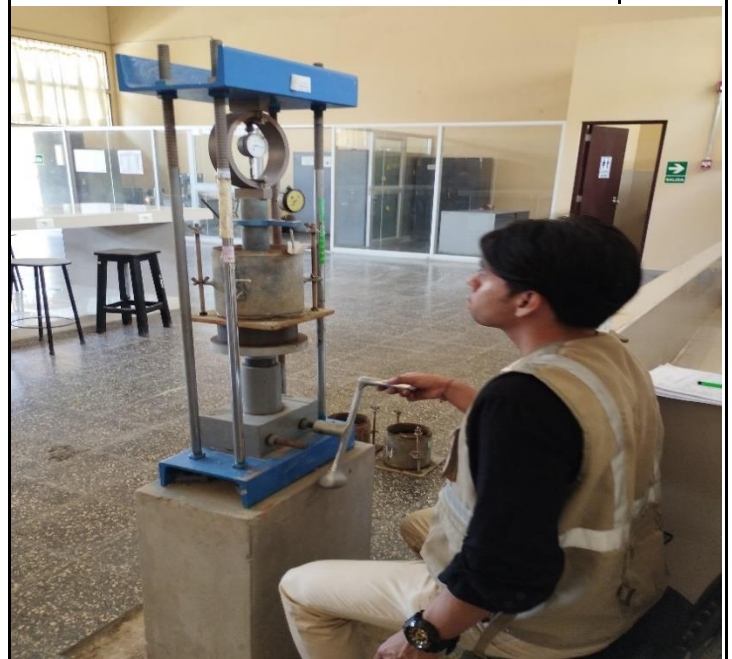
Ensayo CBR-Penetración: Lectura de penetración para diferente presión según la normativa establecida
