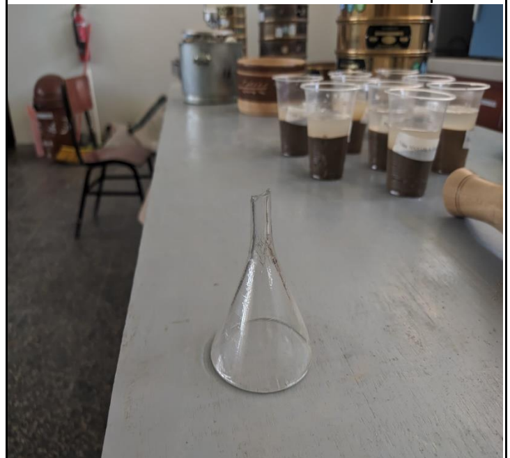
Ensayo Sales Totales: Embudo utilizado en el proceso de filtración FOTO 56
