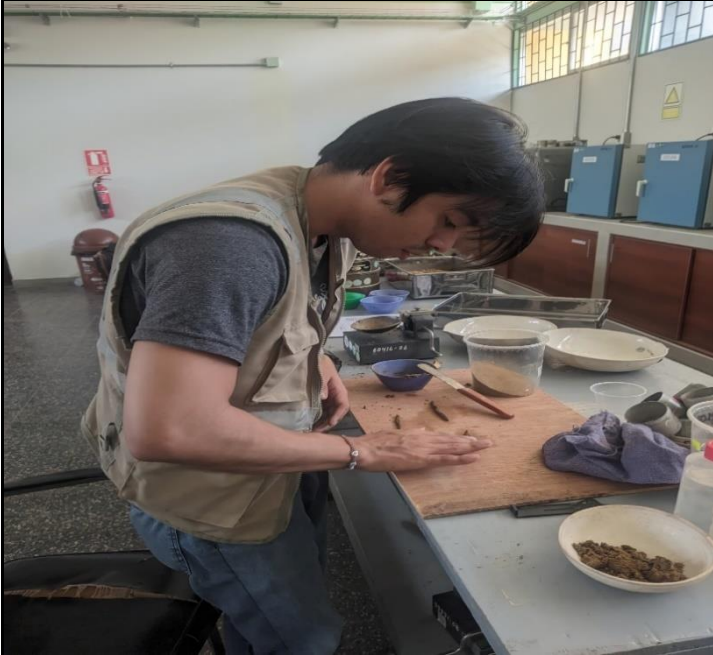
Ensayo limite plástico - procedimiento: Formación de rollos con un diámetro aproximado de 3.2 mm
