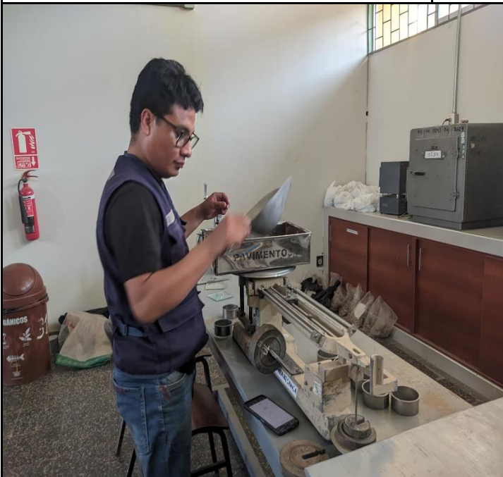
Ensayo Granulometría (Procedimiento) : Pesado de las muestras
