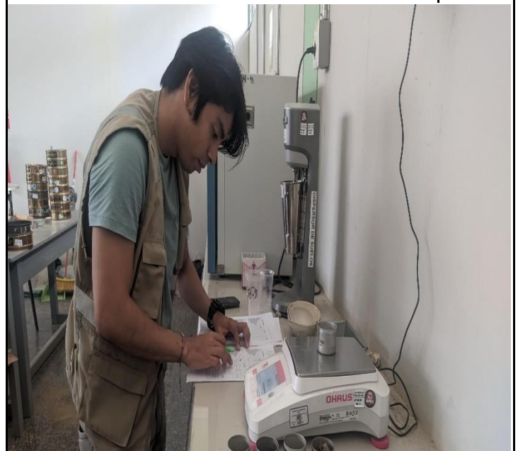
Ensayo Contenido de Humedad - procedimiento: Pesado de muestra de afirmado (material de cantera)
