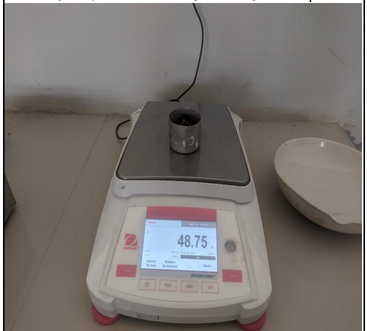
Ensayo Limite Liquido - procedimiento: Pesado de muestra húmeda extraída de la copa de Casagrande FOTO 40
