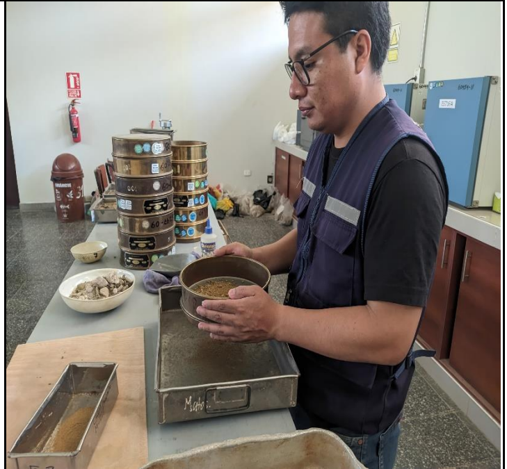
Ensayo L.L y L.P: Tamizado del material de afirmado para realizar el
