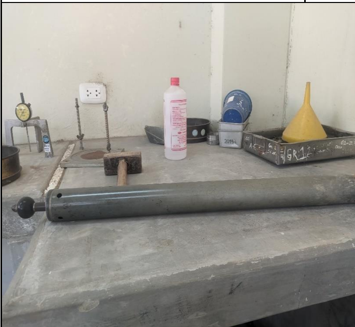
Ensayo CBR: Pison mecánico utilizado para la compactación de muestras
