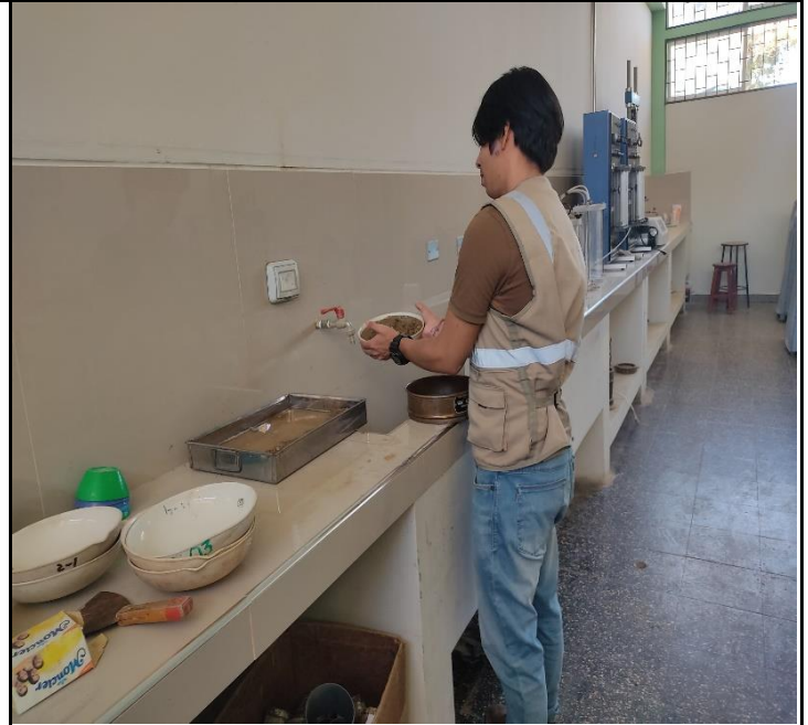
Ensayo Granulometría (Procedimiento): Lavado de material por la malla N° 200
