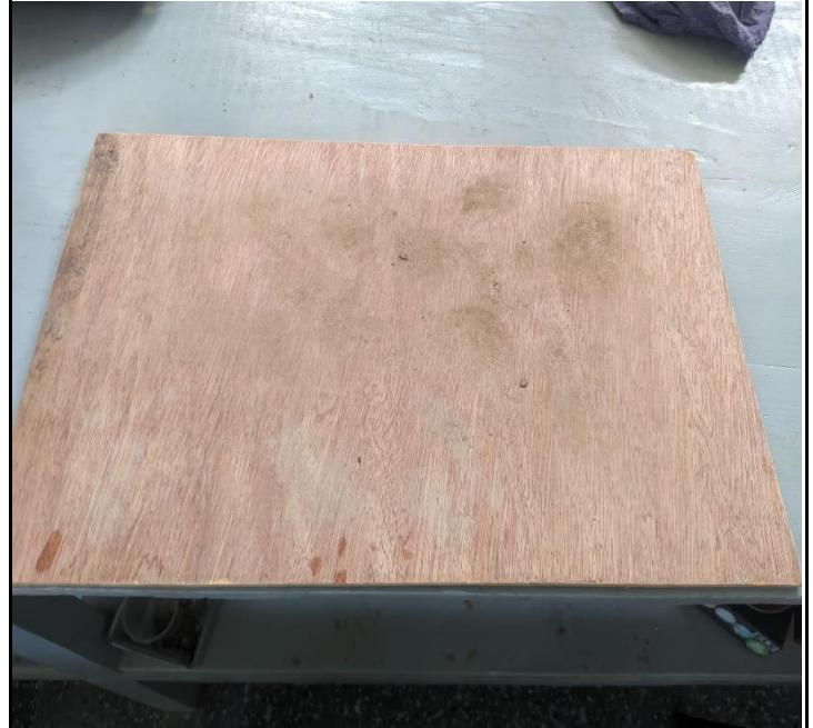
Material utilizado para la formación de los rollos en el ensayo de limite plástico
