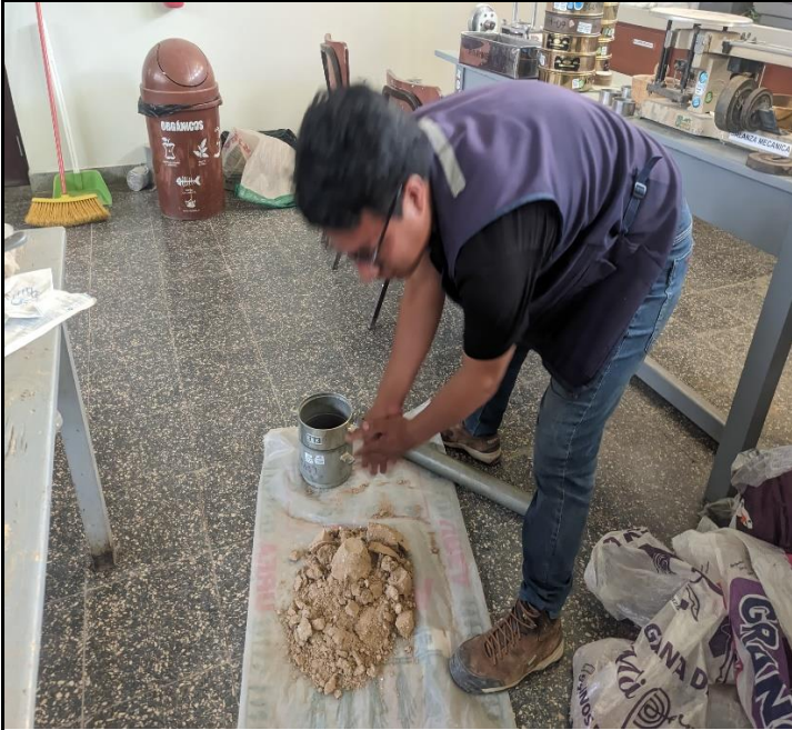
Ensayo Proctor Modificado: Humedecimiento y mezcla la muestra pasante por el tamiz 40
