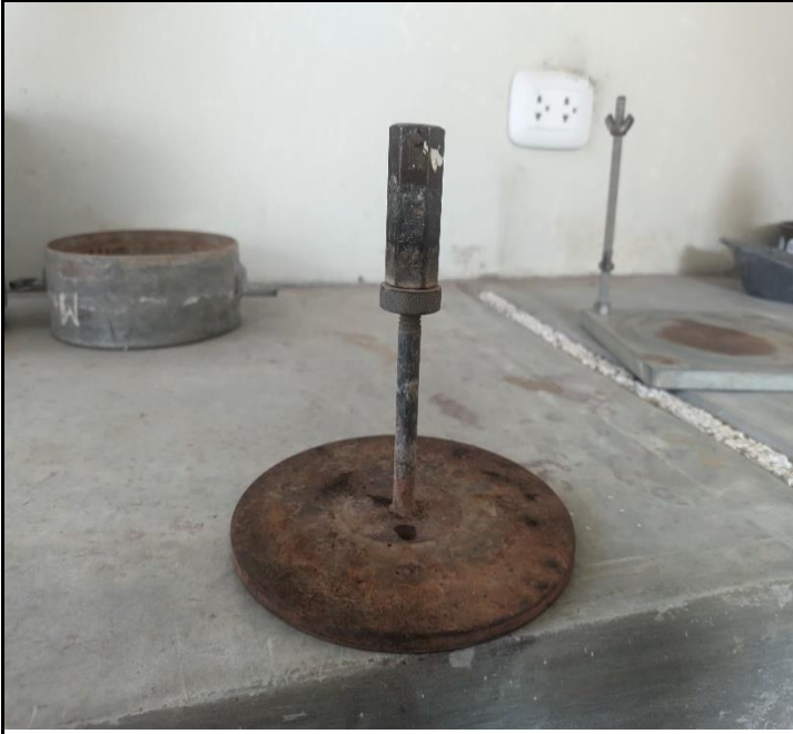
Ensayo CBR: Vástago , colocado sobre la muestra compactada dentro del molde
