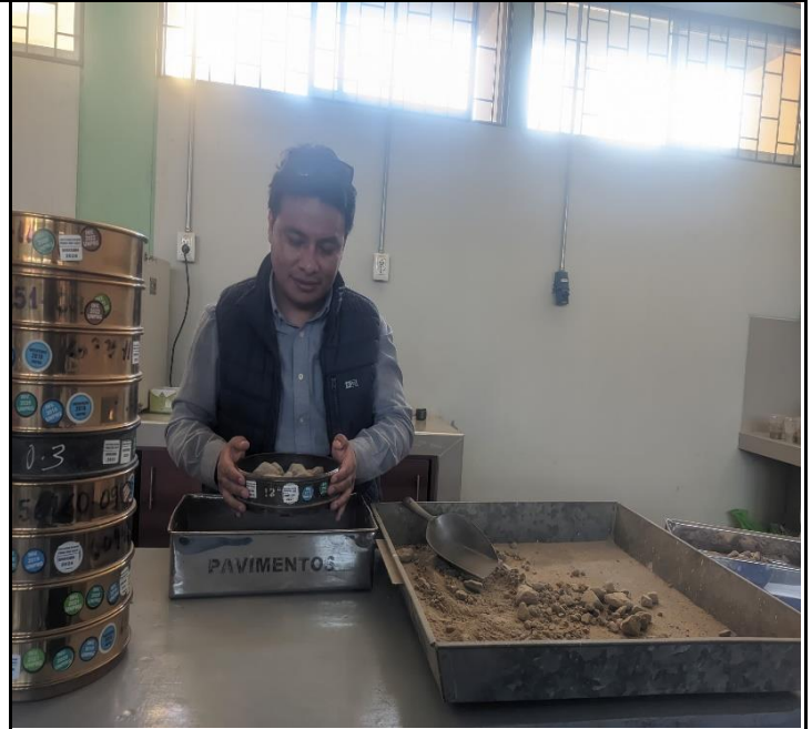
Ensayo de Abrasión: Tamizado de muestra
