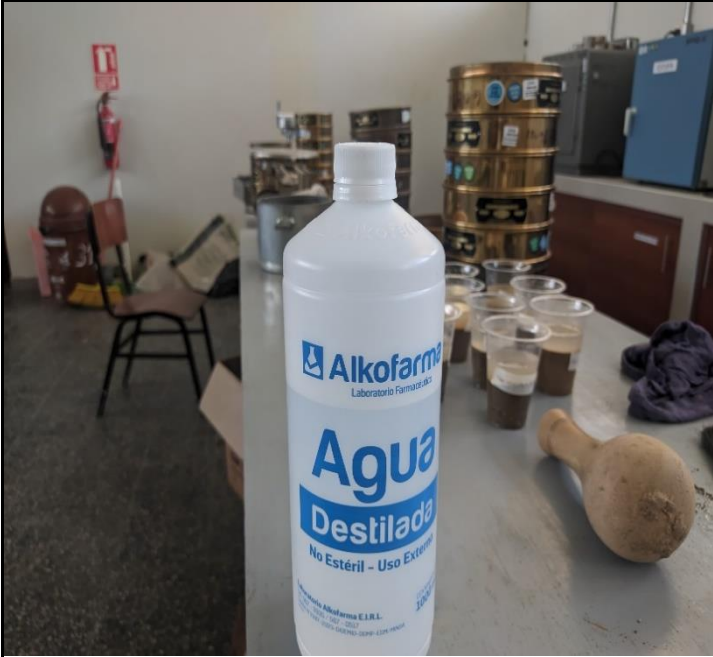
Ensayo Sales Totales: Agua destilada utilizada para extraer las sales solubles presentes en las muestras de suelo FOTO 53
