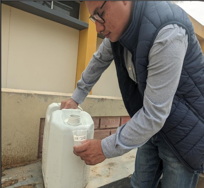
Extracción de muestra de agua de mar para realizar las combinaciones con el material de cantera para ensayos
