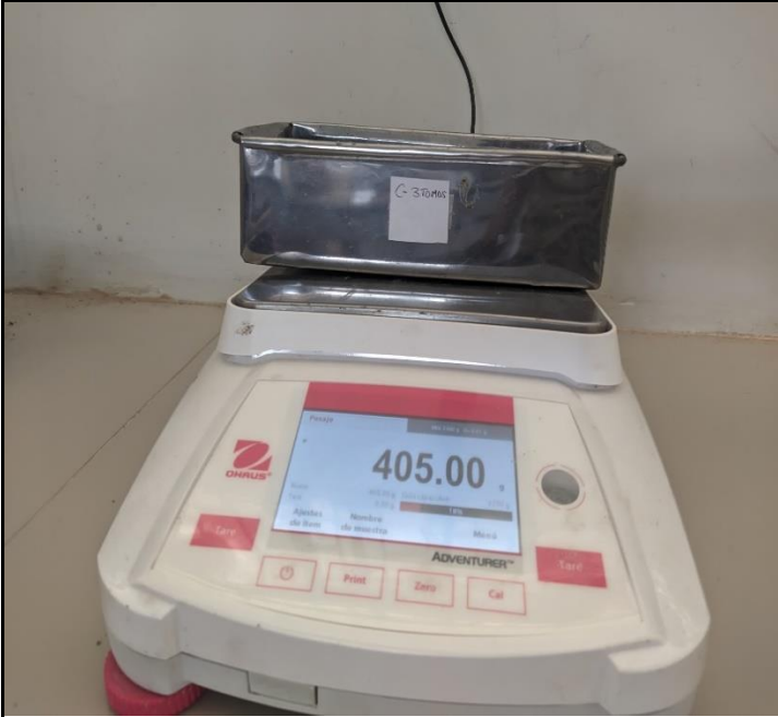
Ensayo Granulometría (Procedimiento): Pesado de material de cantera (afirmado) en la balanza de precisión
