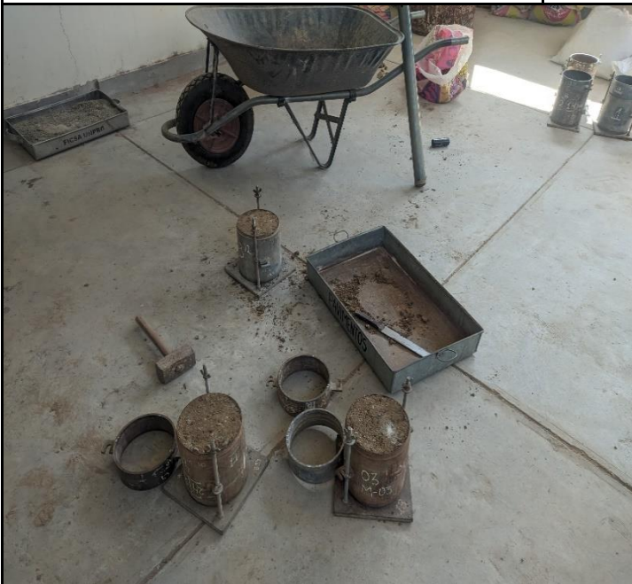
Ensayo CBR: Moldes compactados con la muestra para : 56, 25 y 12 golpes FOTO 71
