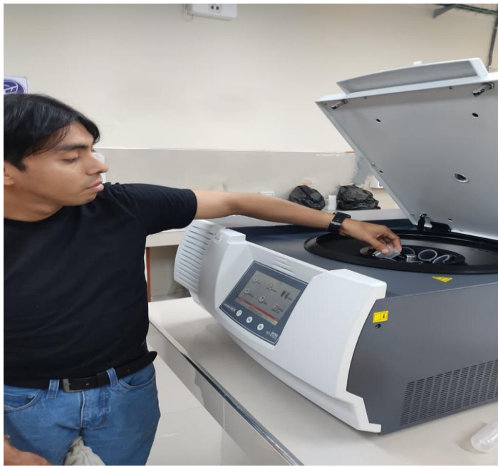
Foto 5: Colocación de tubos de ensayo con las muestras para el ensayo de sulfatos.*
