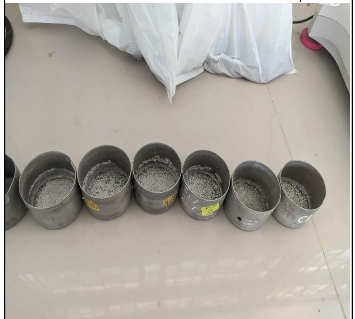
Ensayo Sales Totales (Procedimiento): Pasado las 24 horas en el horno las muestras que contenían el agua filtrada se evaporó, quedando solo las sales
