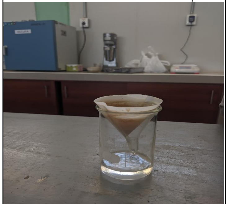
Ensayo Sales Totales: Muestra de afirmado+ agua destilada pasando el papel filtro
