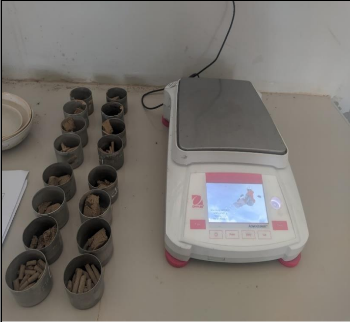
Ensayo Limite Liquido - procedimiento: Pesado de muestras secas luego de colocar al horno
