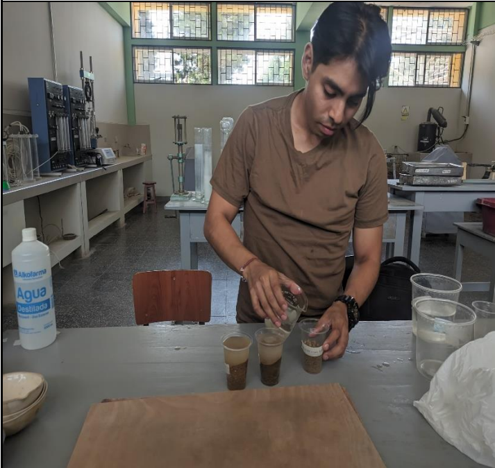
Ensayo Sales Totales: Colocación de agua destilada a las muestras de material de cantera
