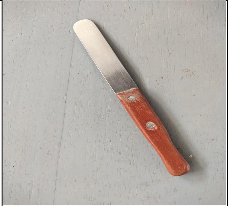
Espátula utilizada para los ensayos de L.L- L.P dentro del laboratorio de mecánica de suelos-FICSA
