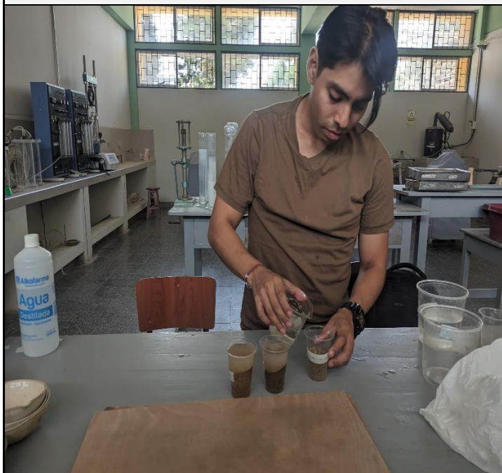
Ensayo Sales Totales: Colocación de agua destila a las muestras de material de cantera
