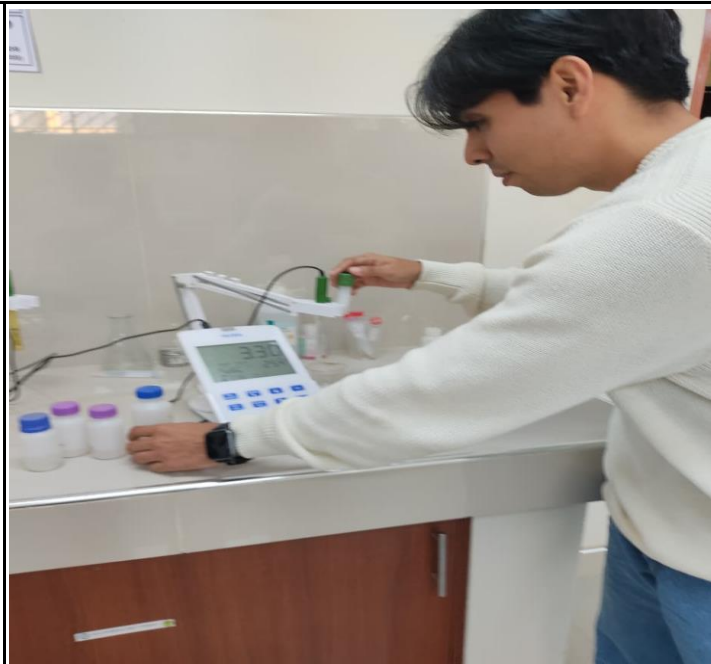
Foto 2: Conductivimetro utilizado para determinar la salinidad de las muestras.*
