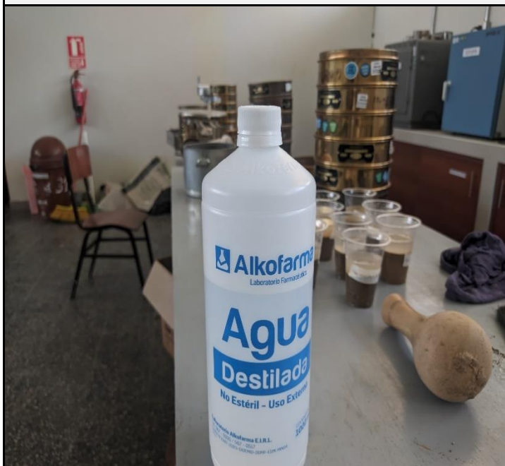
Ensayo Sales Totales: Agua destilada utilizada para extraer las sales solubles presentes en las muestras de suelo
