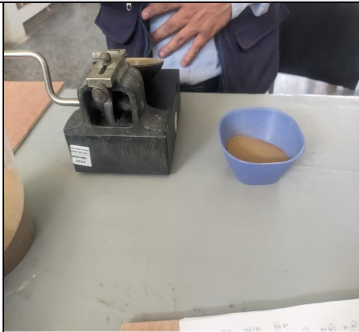
Ensayo Limite Liquido - procedimiento: Mezcla homogénea y uniforme en la copa de Casagrande
