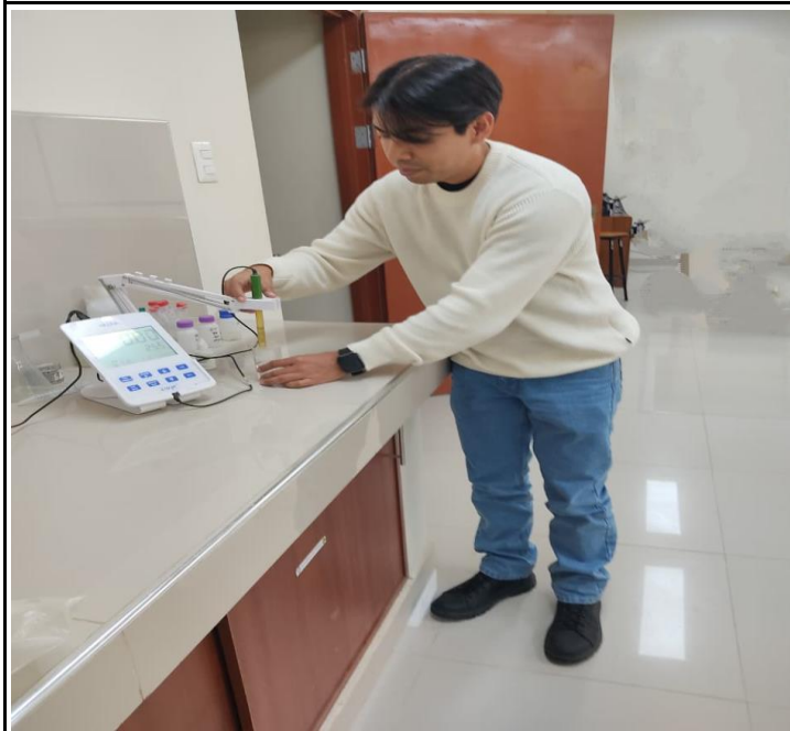
Foto 1: Phmetro utilizado para determinar el PH de cada muestra.*
