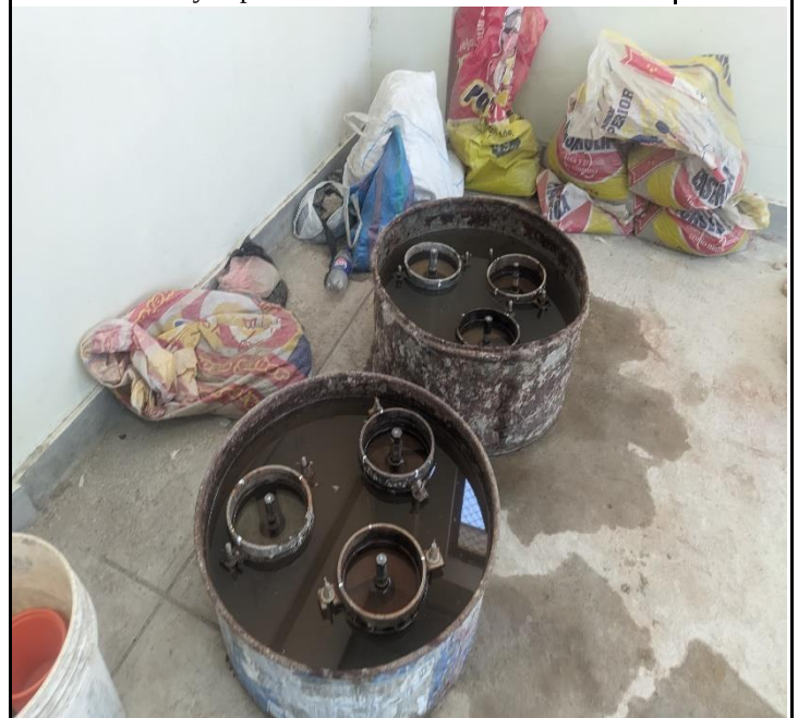
Ensayo CBR - procedimiento: Moldes compactados sumergidos en el agua por 4 días
