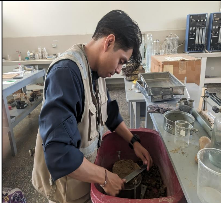
Ensayo Proctor Modificado: Enrasado de material en molde luego de la compactación
