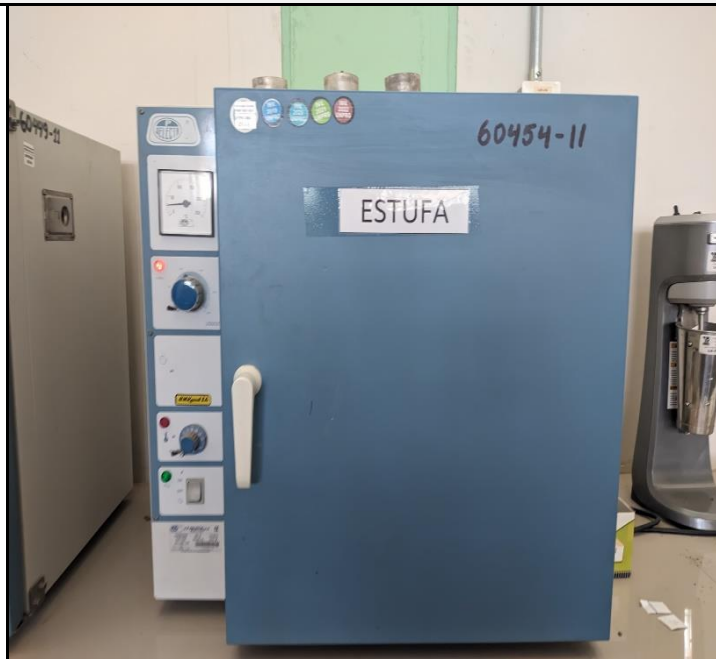
Horno de laboratorio con una temperatura de: 105 °C a 110 °C para secar muestras de suelo
