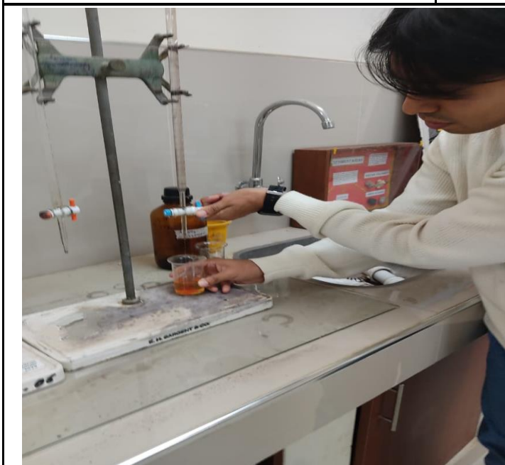
Foto 4: Reaccion (cambio de color por el nitrato de plata) para el metodo de titulacion.*
