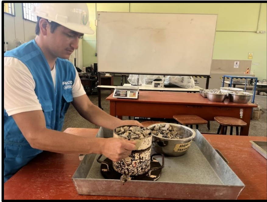
Figura 14: Llenado del molde cilíndrico con agregado
