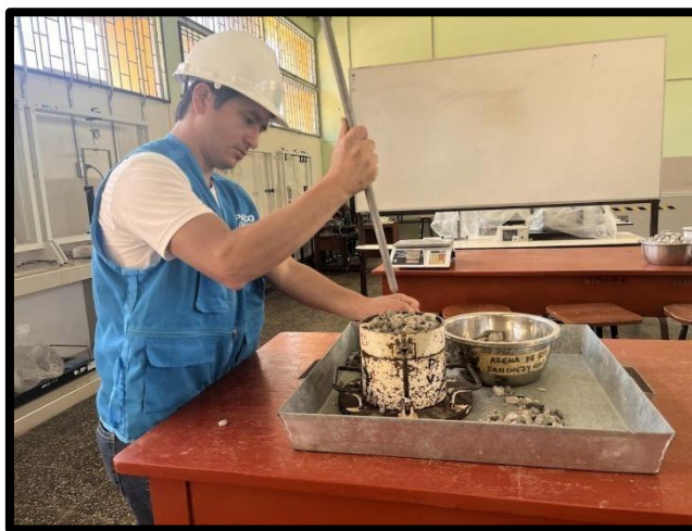
Figura 15: Varillado del Ag. Grueso
