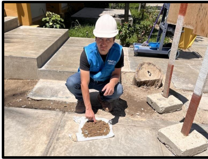
Figura 16: Secado de la muestra de Ag. Fino
