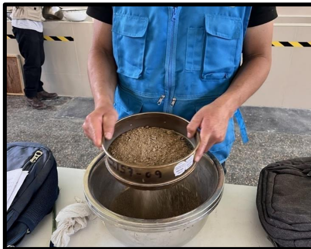
Figura 17: Tamizado por la malla n°4 para eliminar las partículas externas
