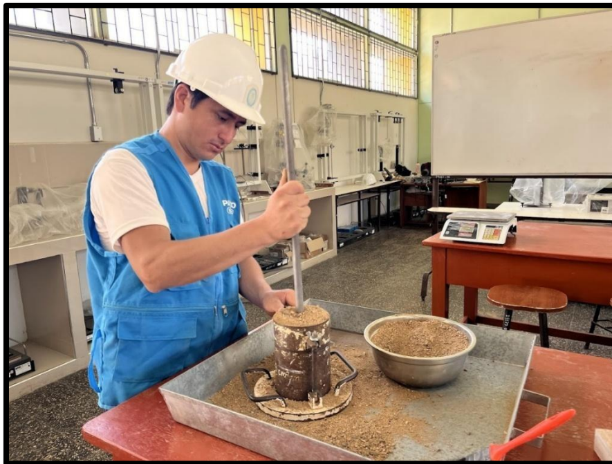
Figura 13: Varillado de la muestra a ensayar
