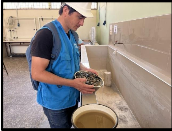
Figura 20: Separación del agua del Ag. Grueso
