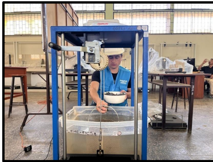
Figura 22: Colocación de la balanza para el ensayo de peso específico de masa del Ag. Grueso
