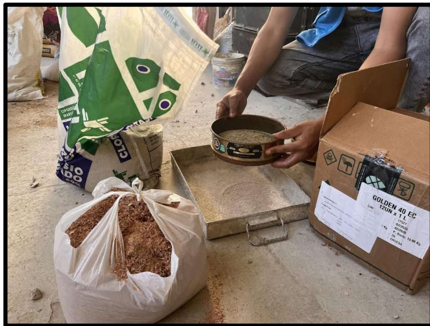
Figura 06: Tamizado de las cenizas de cascarilla café
