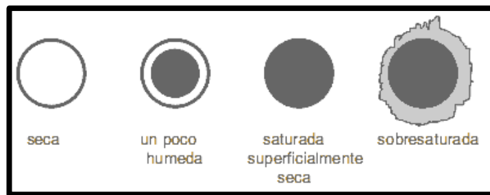
Figura 07: Saturación del agregado fino
