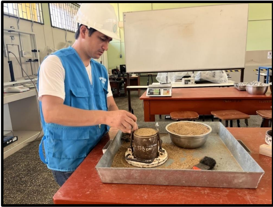
Figura 12: Llenado del molde cilíndrico con arena
