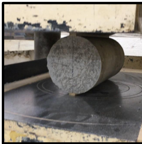
Figura 04: Posicionamiento de la probeta para la rotura a tracción indirecta
