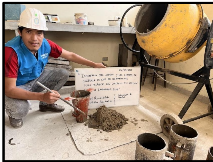
Figura 01: Verificación del asentamiento del concreto fresco preparado en las instalaciones del laboratorio de materiales de la FICSA- UNPRG
