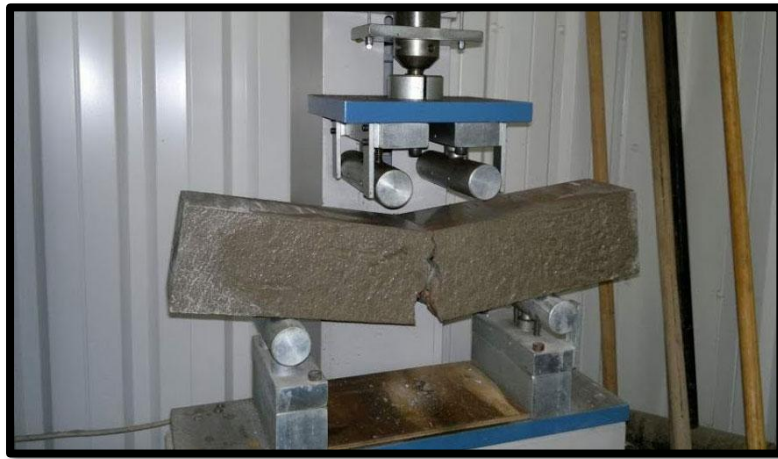
Figura 05: Muestra de la realización del ensayo de flexión en la prensa
