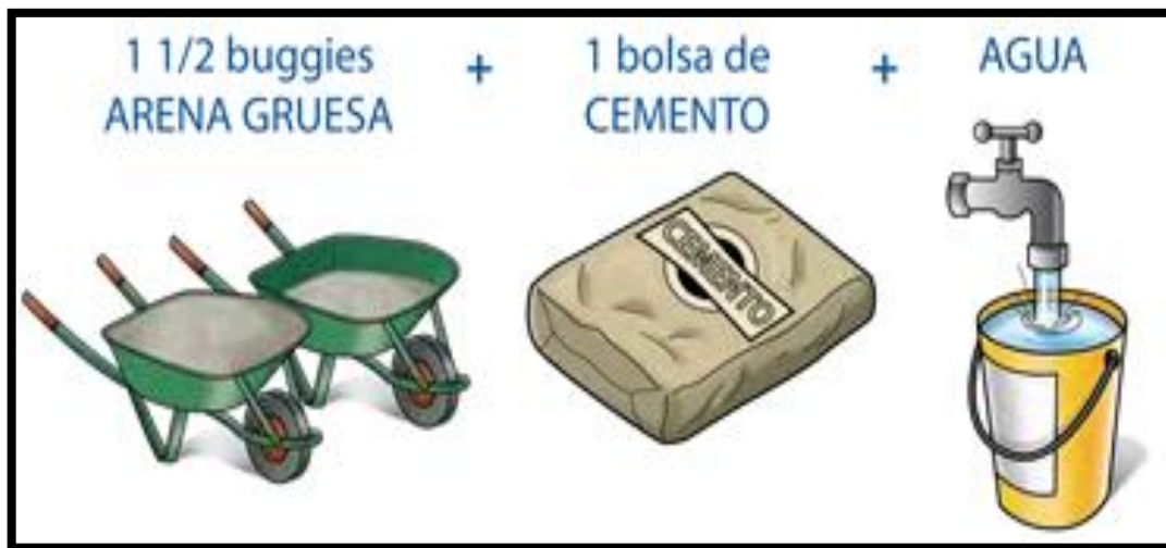
Figura 3.3: Dosificación del mortero Fuente: Aceros Arequipa
