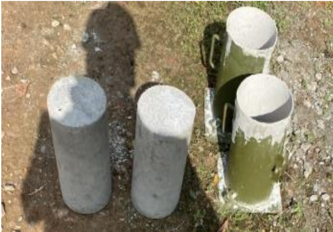
Foto 7 Elaboración de testigos de concreto de los elementos estructurales
