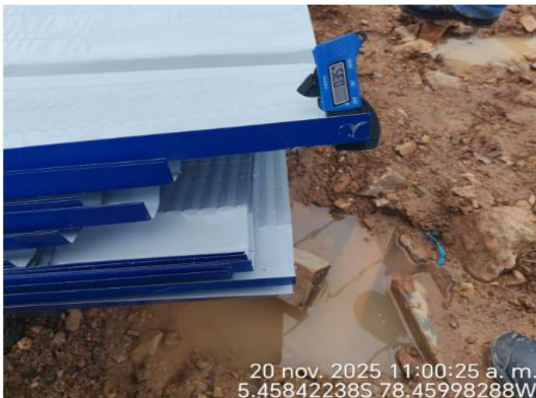
Foto 32. Control del espesor de aluzinc, según lo especificado en el expediente técnico aprobado.
