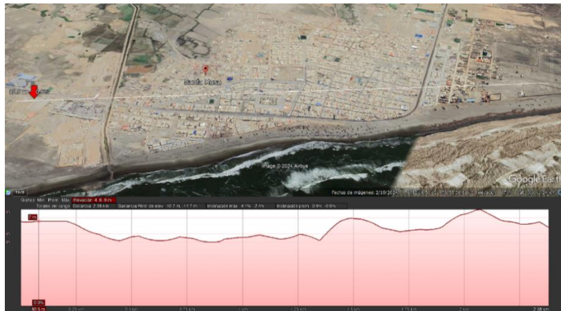
Figura 6: Vista corte topográfico 1
