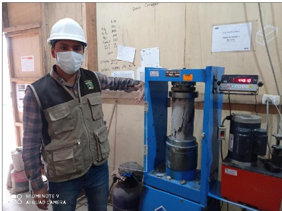
Foto 12 Presencia en Rotura de Probetas de las estructuras del proyecto
