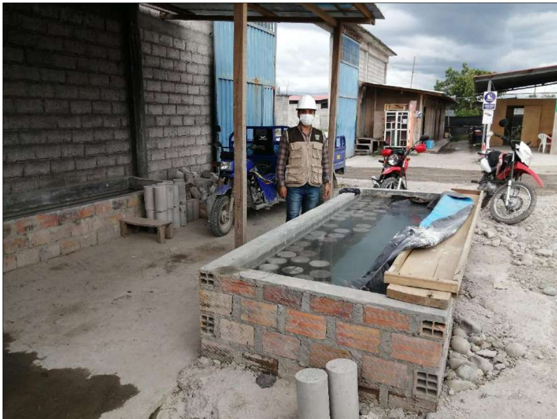
Foto 22 Presencia en Planta Concretera de la Contratista, y se verifican las probetas de concreto de las estructuras del proyecto.
