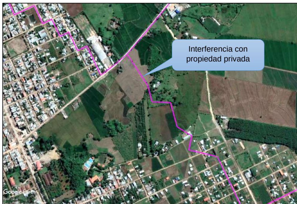
Figura 71. Tramo de la red colectora con Interferencia evidenciada en obra.
