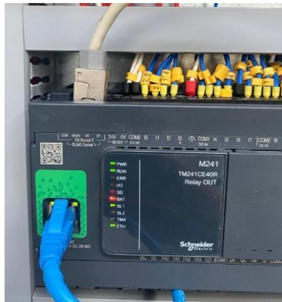
Figura 42 - Comunicación serial de datos con el controlador.
