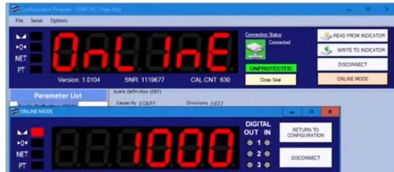
Figura 37 - Conexión online con celda de carga.
