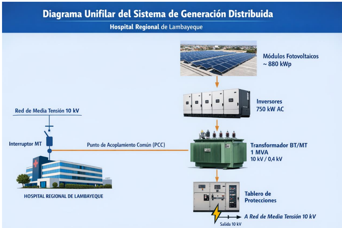
Figura 1: Diagrama Unifilar del Sistema de Generación Distribuida
