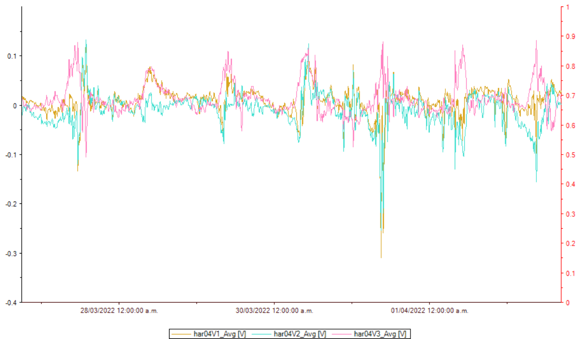
Figura 17: Armónico de tensión de cuarto grado en las 3 fases
