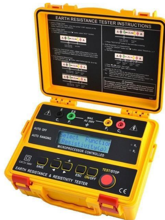
Figura 21: Telurómetro utilizado en la medición
