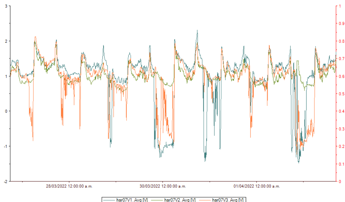
Figura 15: Armónico de tensión de séptimo grado en las 3 fases
