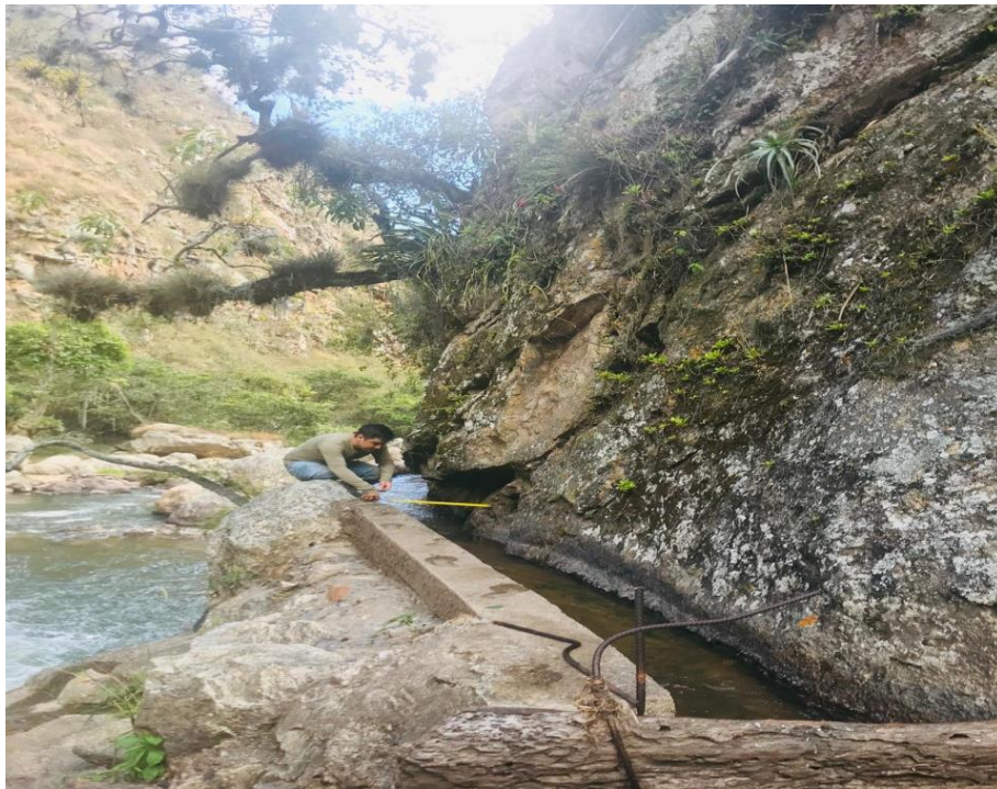
Fotografía 10. Medición de un tramo recto y uniforme del canal para realizar el aforo.
