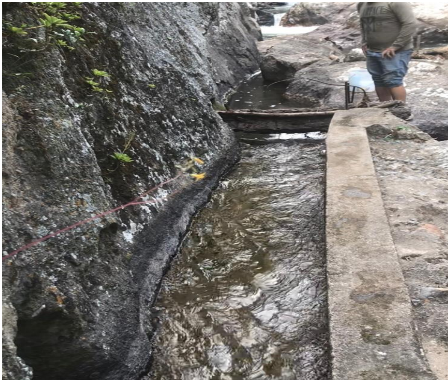
Fotografía 11. Aforo de la sección del canal mediante el método del flotador, se utilizo una botella plástica.
