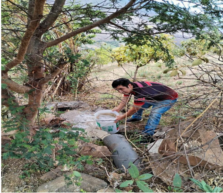
Fotografía 9. Aforo mediante el método del balde en la toma.
