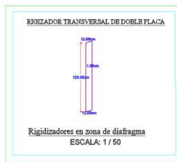
Figura 40. Sección laminar, rigidizador en región de diafragma
