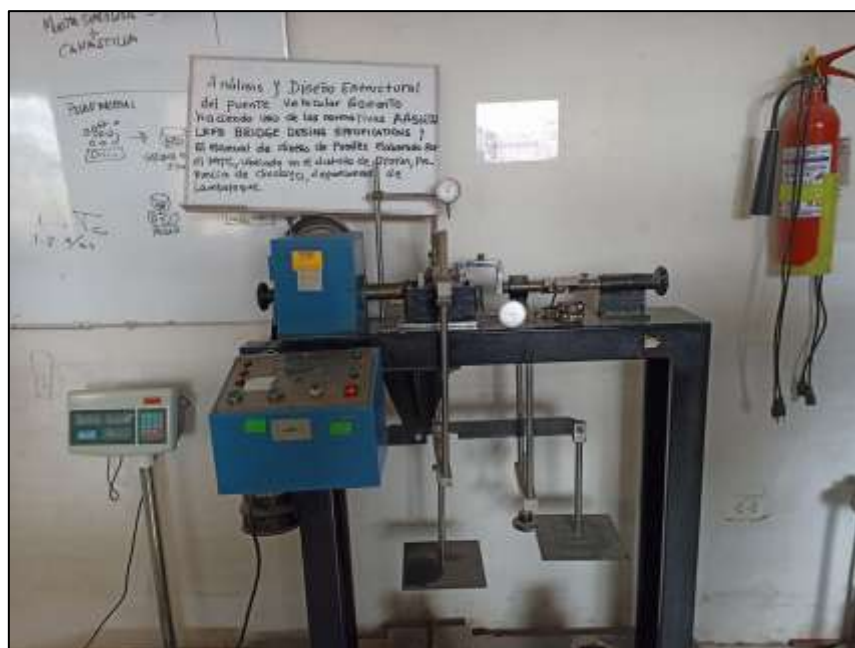
Figura 25. Determinación de la resistencia al corte mediante ensayo de corte directo
