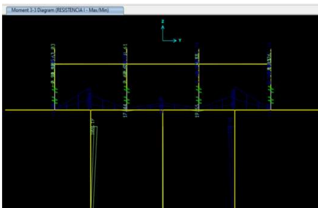
Figura 106. Diagrama de Momento Flector por Resistencia I
