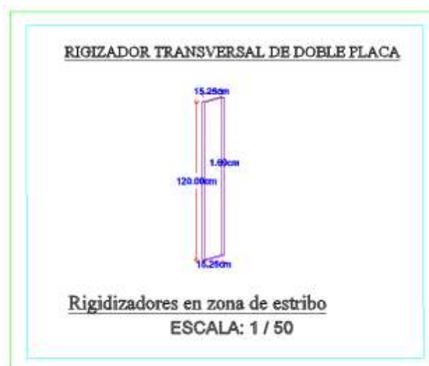
Figura 41. Sección laminar, rigidizador en zona de estribo
