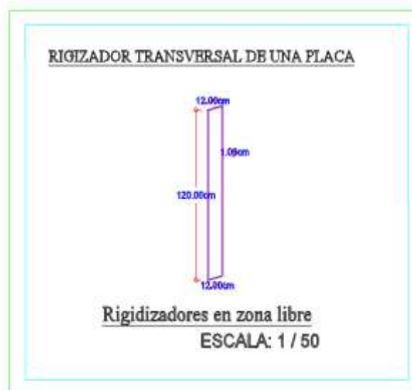
Figura 42. Sección laminar, rigidizador en zona libre
