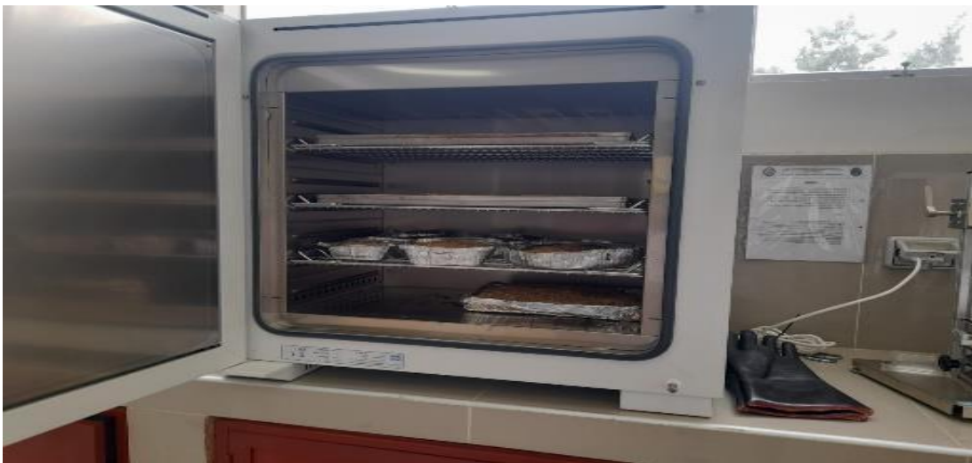
Figura 10: materia prima en la estufa a 110°C por 24 horas para quitar humedad.
