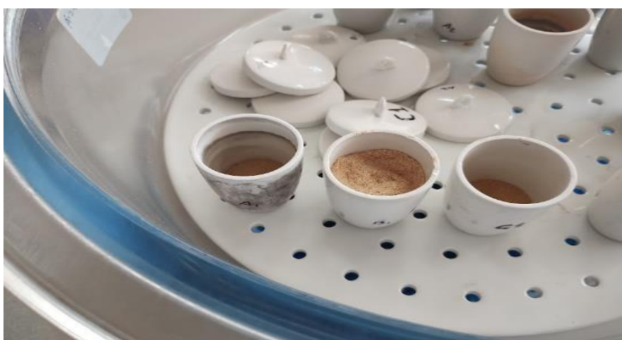
Figura 16: peso inicial antes de ser llevadas a la estufa de las tres muestras de biomasa bagazo de caña, cascarilla de arroz y cascarilla de café, para obtener la humedad.
