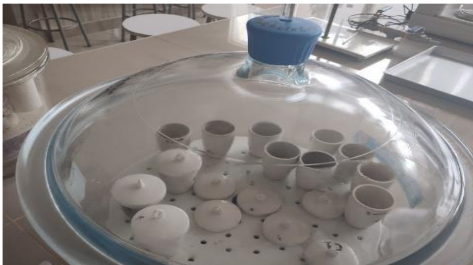
Figura 15: crisoles acondicionados en el humificador
