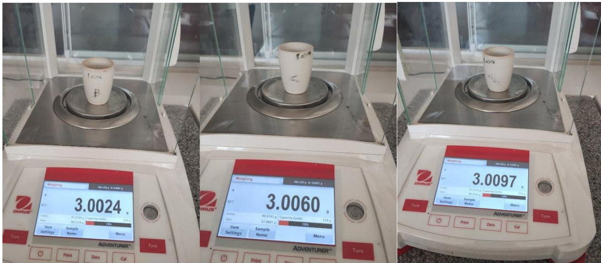
Figura 20: peso inicial de las tres muestras antes de ser llevadas a la mufla para ceniza, bagazo de caña, cascarilla de café, cascarilla de arroz.
