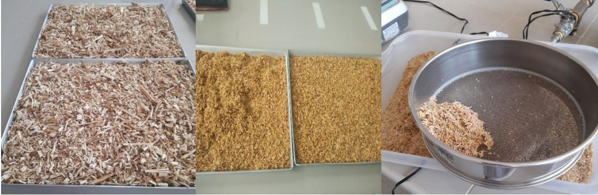
Figura 9: acondicionamiento de la materia para quitar humedad.
