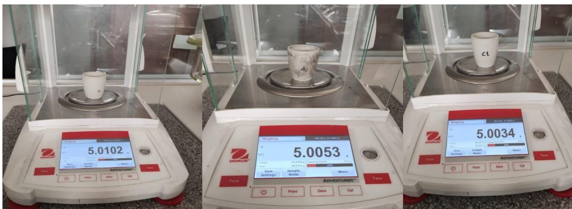
Figura 16: peso inicial antes de ser llevadas a la estufa de las tres muestras de biomasa bagazo de caña, cascarilla de arroz y cascarilla de café, para obtener la humedad.
