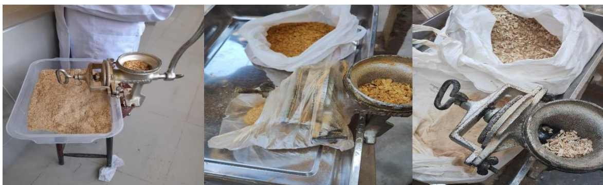
Figura 11: molienda de la materia para facilitar la obtención de la granulometría requerida con ayuda de un molino manual.
