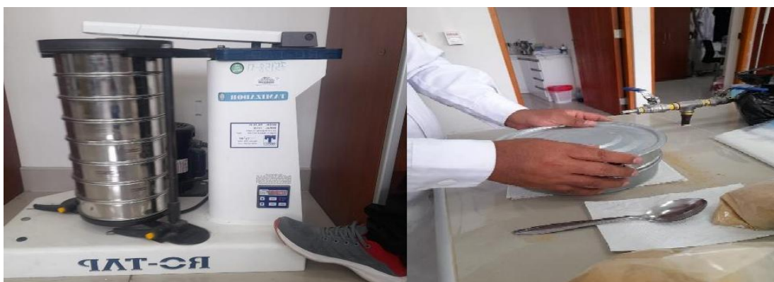
Figura 12: autor obteniendo la malla 600 con la ayuda de un tamizador, del mismo modo autor haciendo uso de una malla 60 manual con la finalidad de mejorar nuestra muestra.
