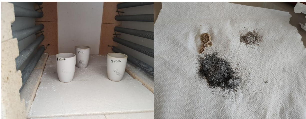
Figura 21: crisoles acondicionados en la mufla hasta alcanzar los 750 °C de forma lenta manteniendo esa condición por 6 horas.
