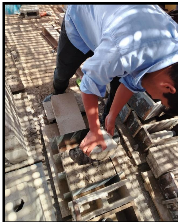
Imagen N° 35: Colocación de la mezcla en los moldes para la elaboración de bloques
