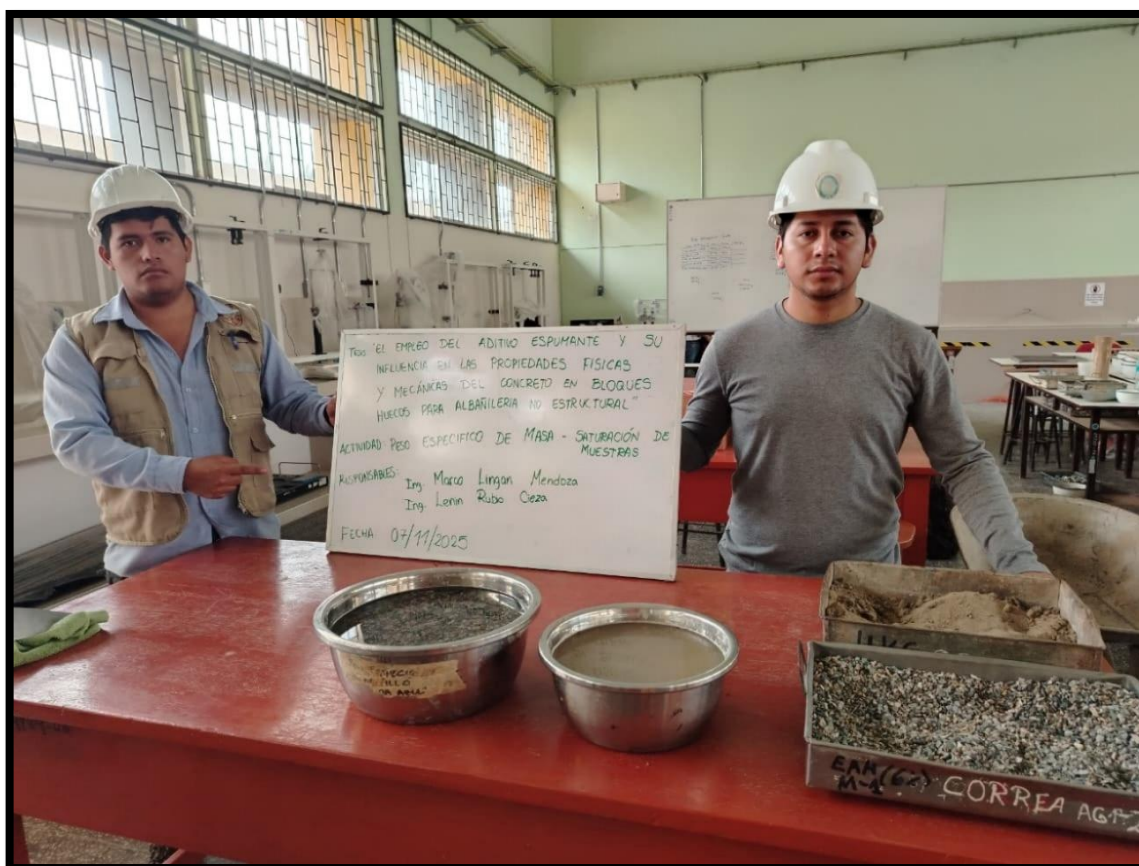
Imagen N° 22: Toma de muestra (5kg) para el ensayo de peso específico de masa.
