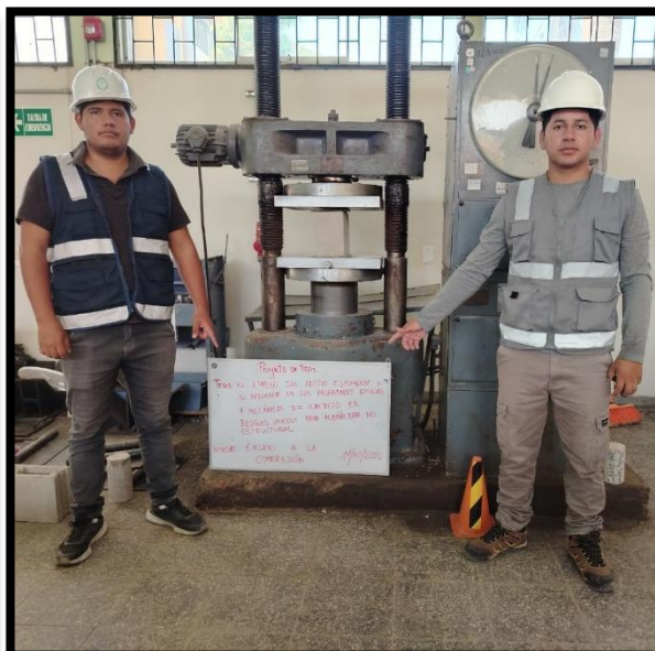
Imagen N° 45: Ensayo a la compresión a los 7 y 14 días (Laboratorio)
