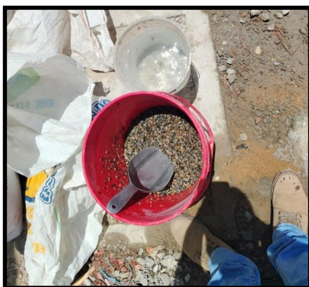
Imagen N° 17: Ensayo de peso específico de masa (lavado de muestra para eliminar impurezas)
