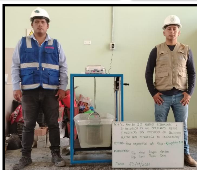
Imagen N° 25: Peso de muestra sumergida en agua
