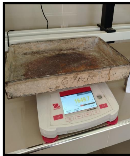
Imagen N° 7: Pesaje de las muestras secas y recipientes (ensayo de contenido de humedad)
