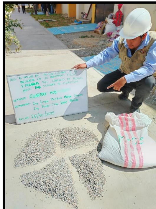
Imagen N° 3: Cuarteo del agregado para la obtención de una muestra representativa.
