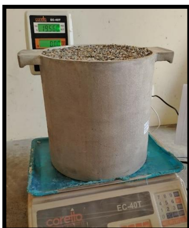
Imagen N° 19: Determinación del peso de la muestra suelta (3 registros-Muestra N°02)
