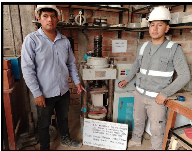
Imagen N° 47: Ensayo a la compresión a los 28 días (Laboratorio De Materiales FICSA)
