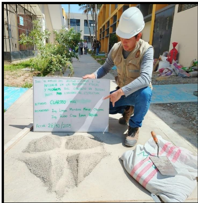
Imagen N° 3: Cuarteo del agregado para la obtención de una muestra representativa.
