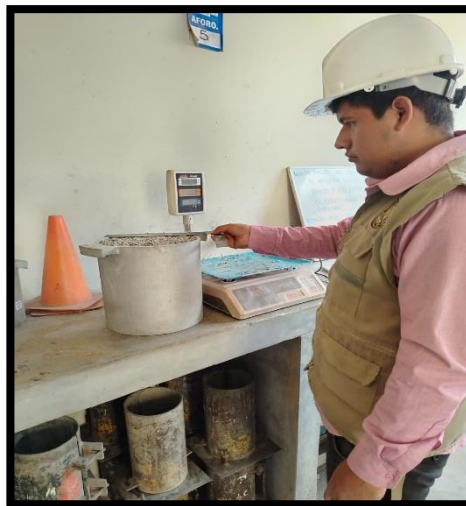
Imagen N° 18: Ensayo de peso volumétrico varillado (Muestra N°02)
