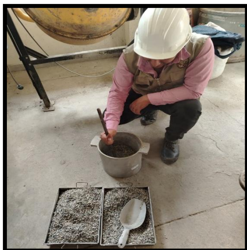
Imagen N° 18: Ensayo de peso volumétrico varillado (Muestra N°02)
