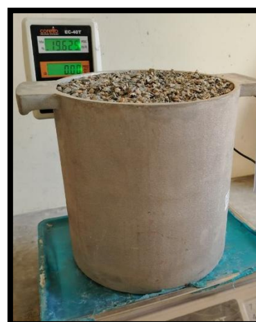
Imagen N° 19: Determinación del peso de la muestra suelta (3 registros-Muestra N°02)
