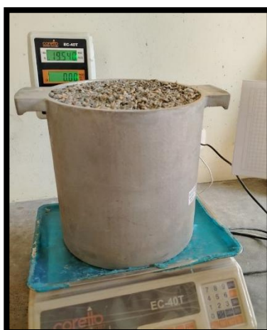
Imagen N° 19: Determinación del peso de la muestra suelta (3 registros-Muestra N°02)
