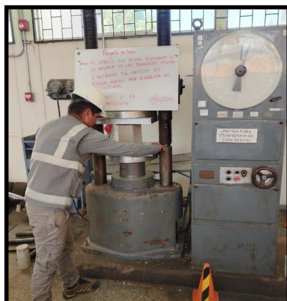
Imagen N° 45: Ensayo a la compresión a los 7 y 14 días (Laboratorio)
