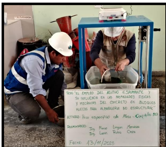
Imagen N° 24: Peso de muestra saturada superficialmente seca
