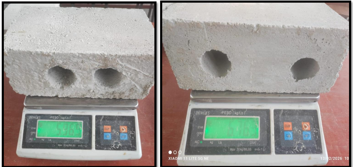
Imagen N° 41: ENSAYO DE CONTENIDO DE HUMEDAD
