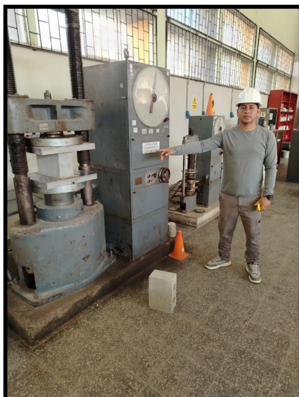
Imagen N° 44: Ensayo a la compresión a los 7 y 14 días (Laboratorio De Materiales FICSA)
