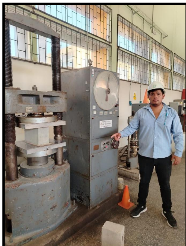
Imagen N° 44: Ensayo a la compresión a los 7 y 14 días (Laboratorio De Materiales FICSA)
