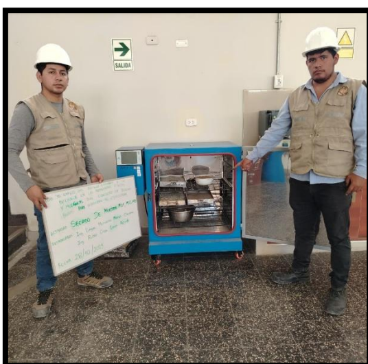
Imagen N° 6: Secado de las muestras en horno hasta alcanzar masa constante, procedimiento previo necesario para los ensayos de contenido de humedad.
