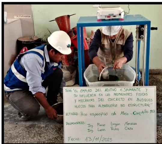
Imagen N° 24: Peso de muestra saturada superficialmente seca
