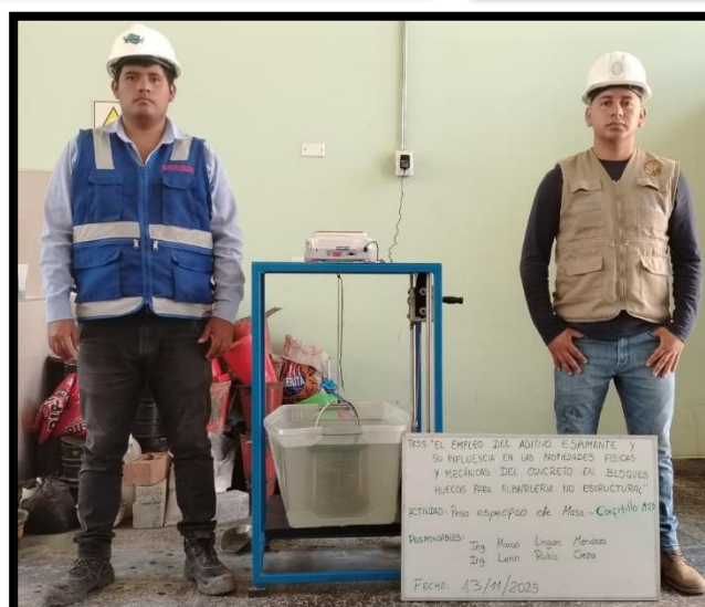
Imagen N° 25: Peso de muestra sumergida en agua
