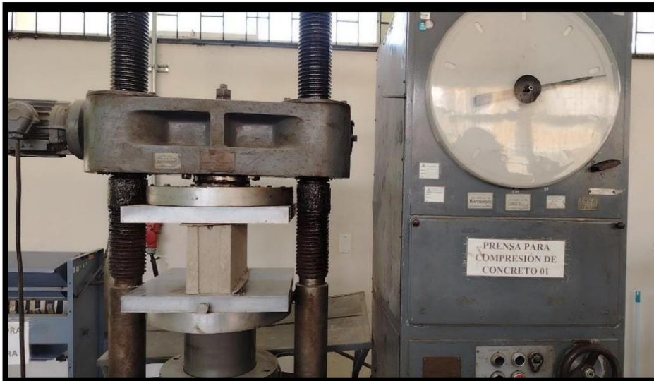
Imagen N° 47: Ensayo a la compresión a los 28 días (Laboratorio De Materiales FICSA)
