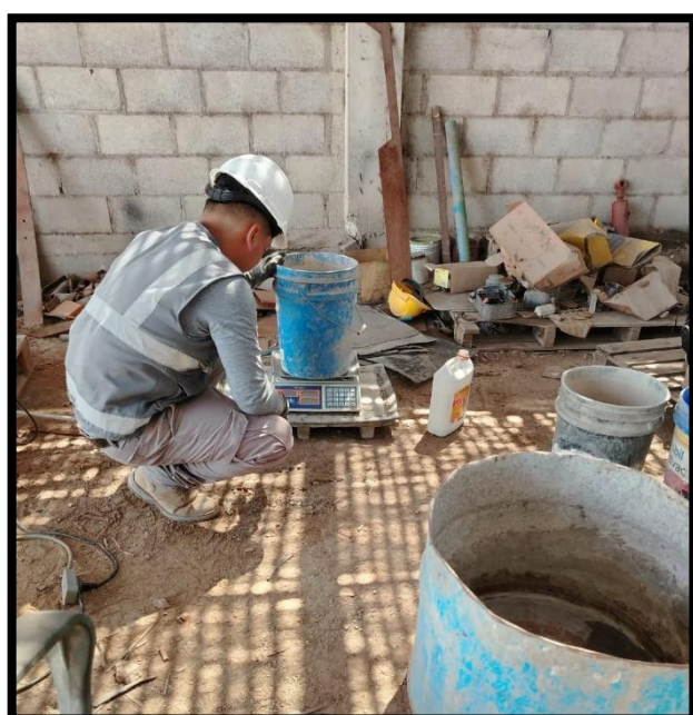
Imagen N° 29: Pesaje de materiales para la preparación de la mezcla según diseño de mezcla.
