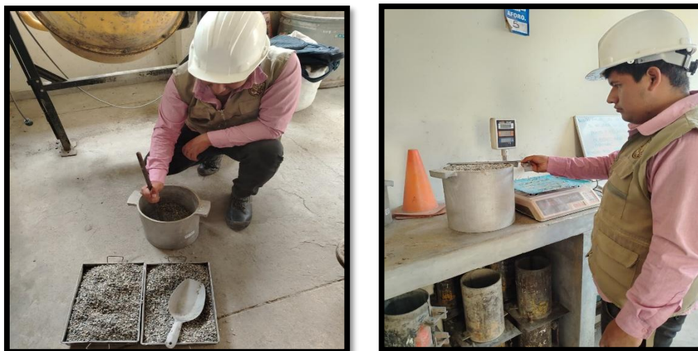
Imagen N° 18: Ensayo de peso volumétrico varillado (Muestra N°02)
