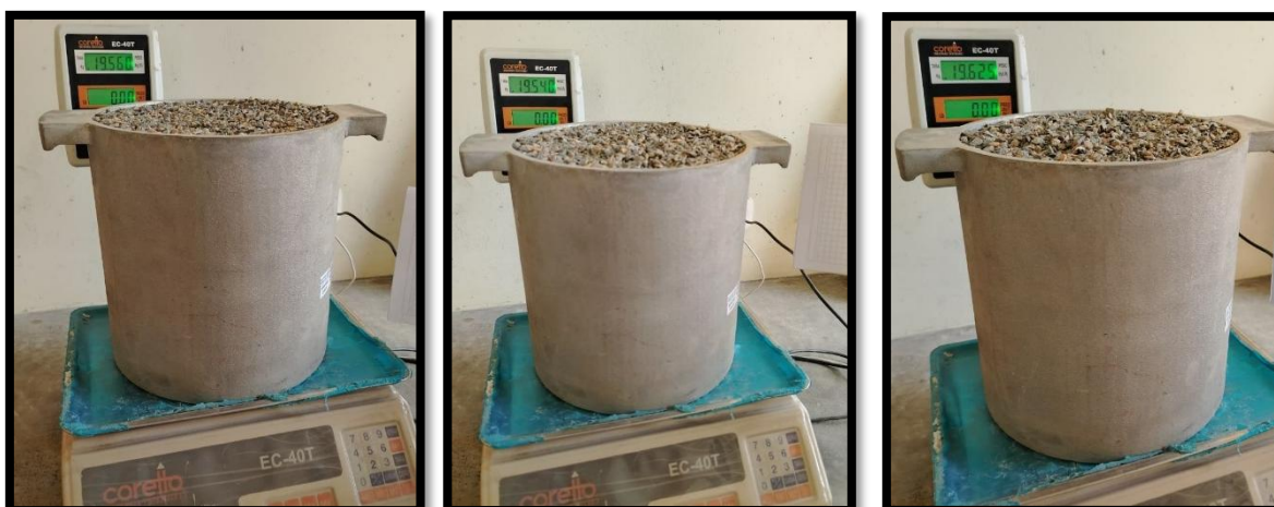
Imagen N° 19: Determinación del peso de la muestra suelta (3 registros-Muestra N°02)
