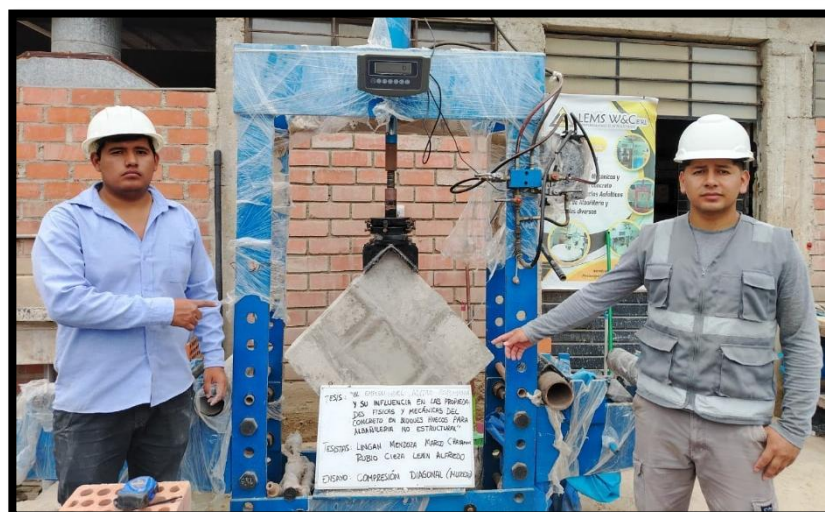
Imagen N° 49: ENSAYO: COMPRESION DIAGONAL (MURETES) (Laboratorio)
