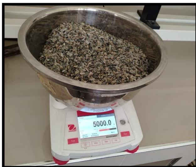
Imagen N° 8: Pesaje de la muestra N° 01 para el ensayo granulométrico.
