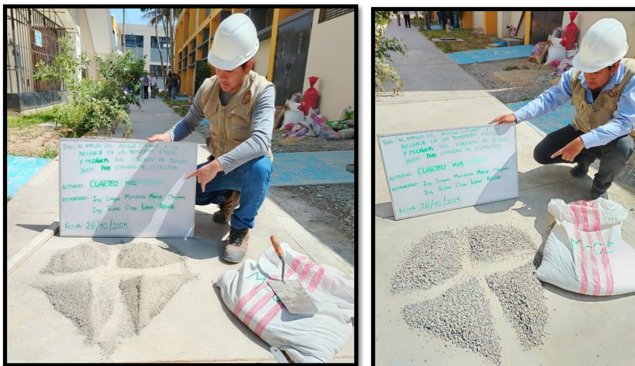
Imagen N° 3: Cuarteo del agregado para la obtención de una muestra representativa.
