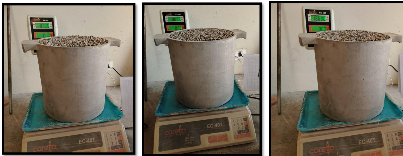
Imagen N° 16: Determinación del peso de la muestra suelta (3 registros – Muestra N°02)
