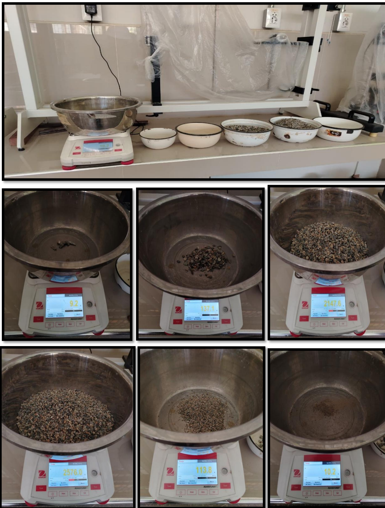
Imagen N° 10: Determinación de la masa del material retenido por tamiz (muestra N°01)
