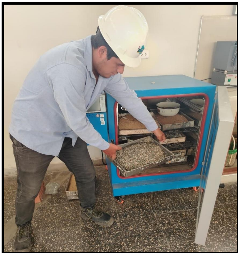
Imagen N° 20: Secado de muestra en horno hasta alcanzar masa constante
