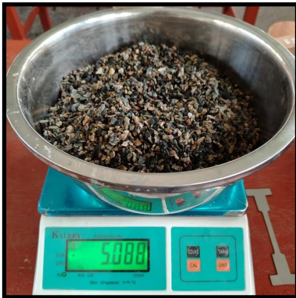
Imagen N° 24: Peso de muestra saturada superficialmente seca
