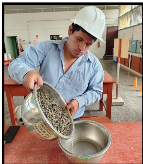
Imagen N° 23: Secado de muestra superficialmente
