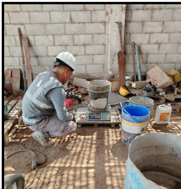
Imagen N° 29: Pesaje de materiales para la preparación de la mezcla según diseño de mezcla.
