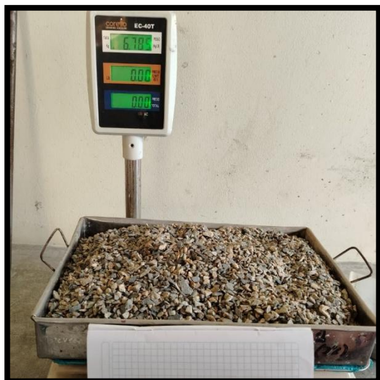
Imagen N° 7: Pesaje de las muestras secas y recipientes (ensayo de contenido de humedad)
