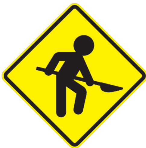
Figura N° 17. PT-1a Trabajos en la vía
