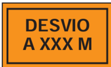
Figura N° 22. ITD-2 Proximidad de desvío
