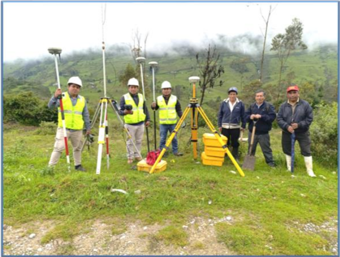
Instalación de la base del GPS Diferencial Trimble R8 para realizar el levantamiento topográfico de las parcelas – El Tambo.
