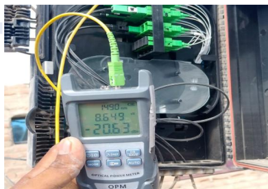
Medidas de potencia óptica de los splitters
