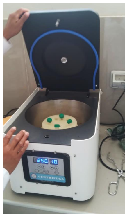
Figura 52: Separación en centrífuga a 250 rpm por 10 min
