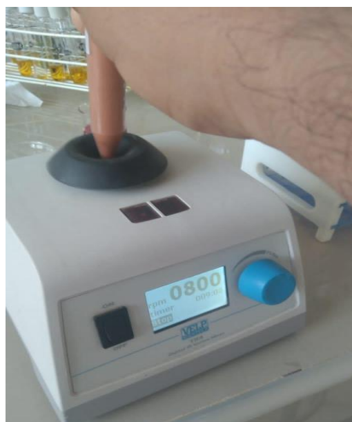
Figura 52: Separación en centrífuga a 250 rpm por 10 min
