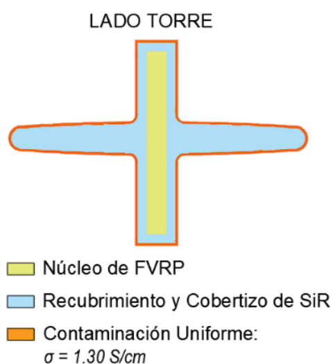
Figura III-21: Representación del Espesor de la Capa Contaminante Uniforme en el Cobertizo Número 16 del Aislador Polimérico
