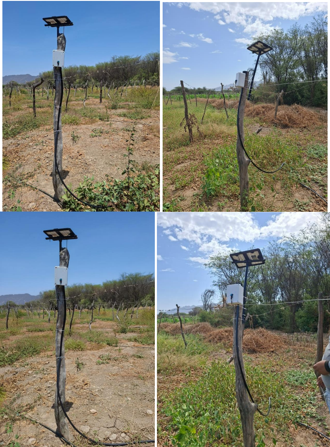
Figura 5. Montaje de los nodos sensores en el cultivo de maracuyá
