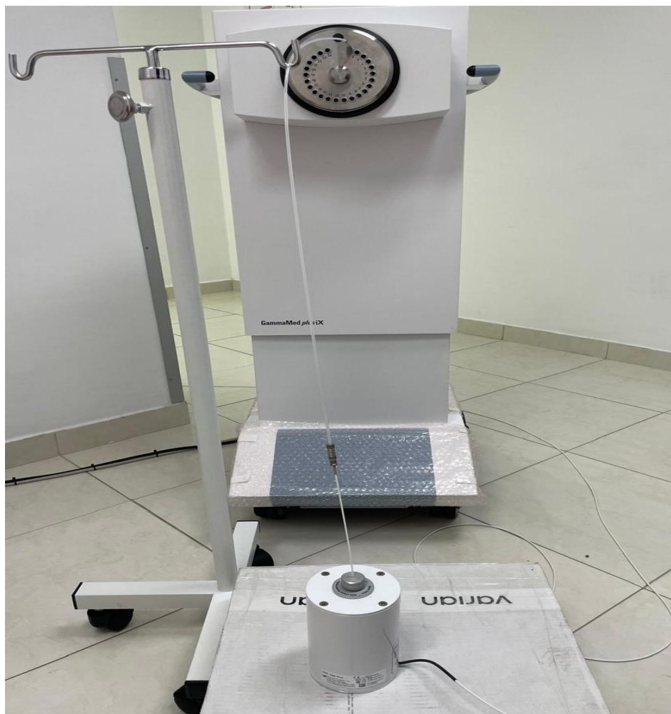
Figura 7. Tubo de transferencia utilizado para el desplazamiento de la fuente radiactiva, Clínica ONCORAD sede Trujillo.
