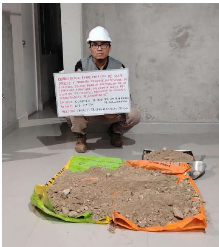
Fotografía 03: Cuarteo de Muestra para ejecución de ensayos de características físicas.
