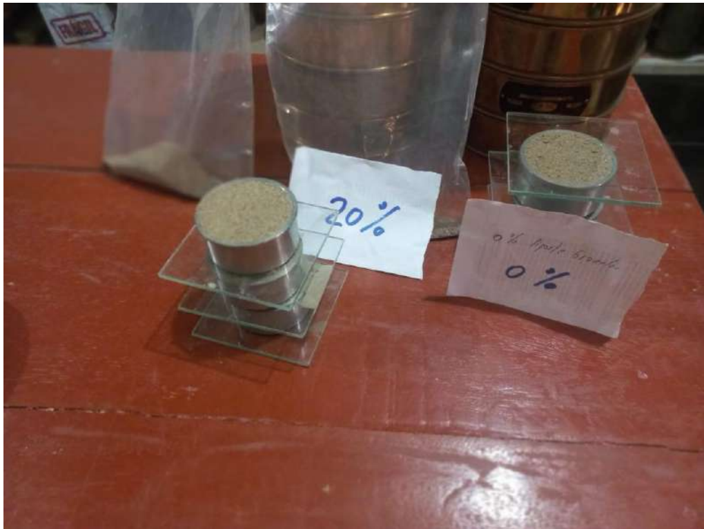
Fotografía 15: Muestra material pasante malla N°4 + 20% de aporte granular. Remoldeado y compactación de muestra para ejecución de ensayo de corte directo.
