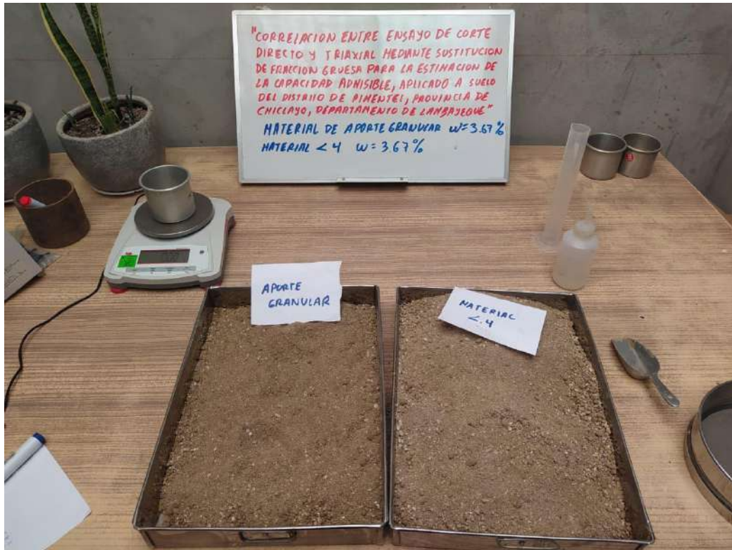
Fotografía 11: Material pasante malla N°4 y material de aporte granular seco al 3.67% de humedad.
