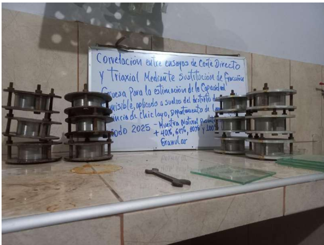
Fotografía 18: Especímenes en moldes previo a ejecución de ensayo de corte directo.
