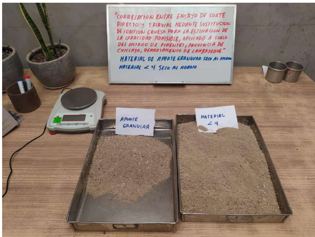
Fotografía 10: Material pasante malla N°4 y material de aporte granular seco al horno.
