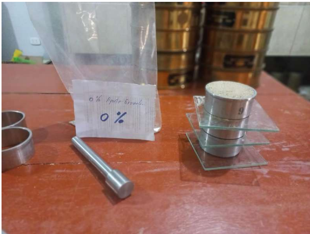
Fotografía 14: Muestra material pasante malla N°4 + 0% de aporte granular. Remoldeado y compactación de muestra para ejecución de ensayo de corte directo.
