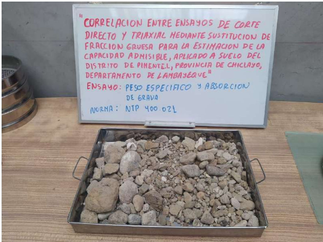
Fotografía 09: Grava seca al horno. Posteriormente se determinó el peso específico y absorción de la grava.
