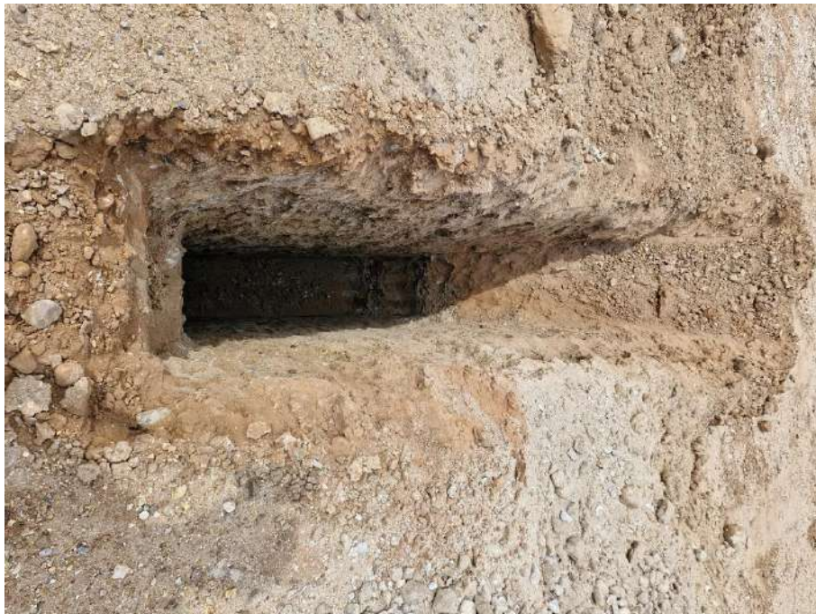
Fotografía 02: Vista de interior de calicata. Visualizándose el contenido de grava, color de la muestra beige, compactidad medianamente densa y contenido de humedad natural.
