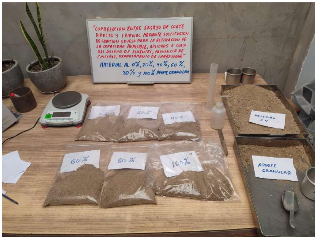
Fotografía 12: Muestras para ejecución de ensayos de corte directo. Material pasante la malla N°4 con porcentajes de aporte granular del 0%, 20%, 40%, 60%, 80% y 100%
