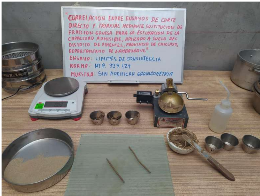
Fotografía 06: Ensayo de límites de consistencia de la muestra sin alteración de granulometría. Se visualiza la determinación del límite líquido y límite plástico.
