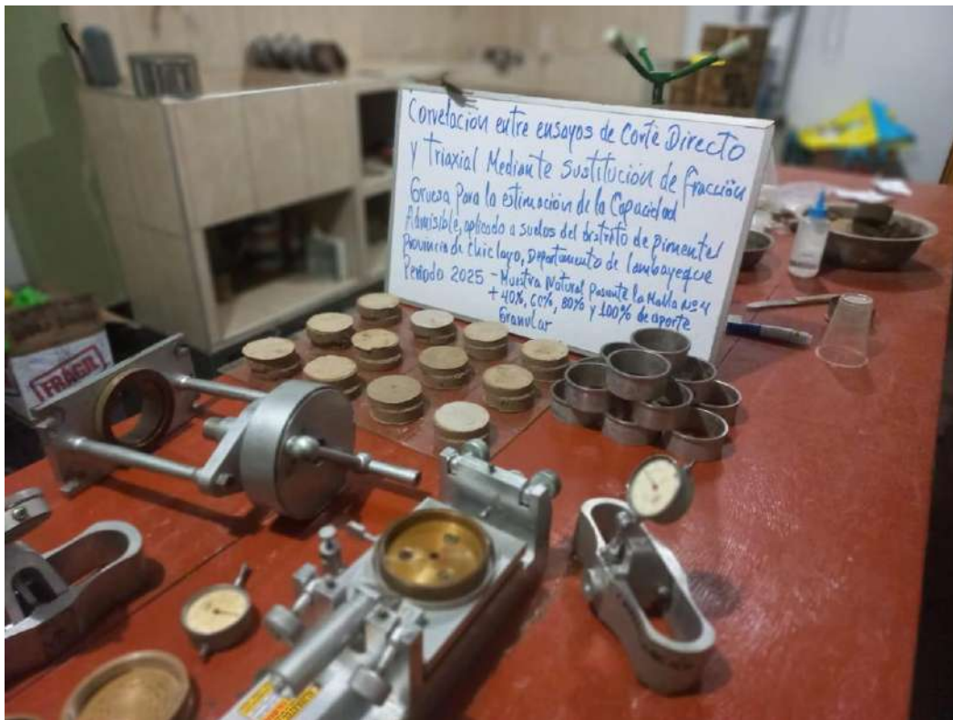
Fotografía 20: Muestran ensayadas bajo carga normal y tangencial al 40%, 60%, 80% y 100% de porcentaje de sustitución de fracción gruesa por arena.
