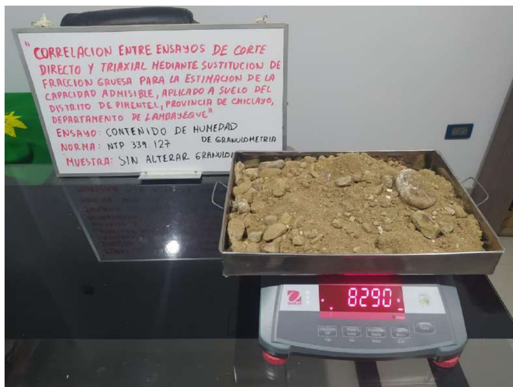
Fotografía 04: Ensayo de contenido de humedad de la muestra sin alteración de la granulometría.
