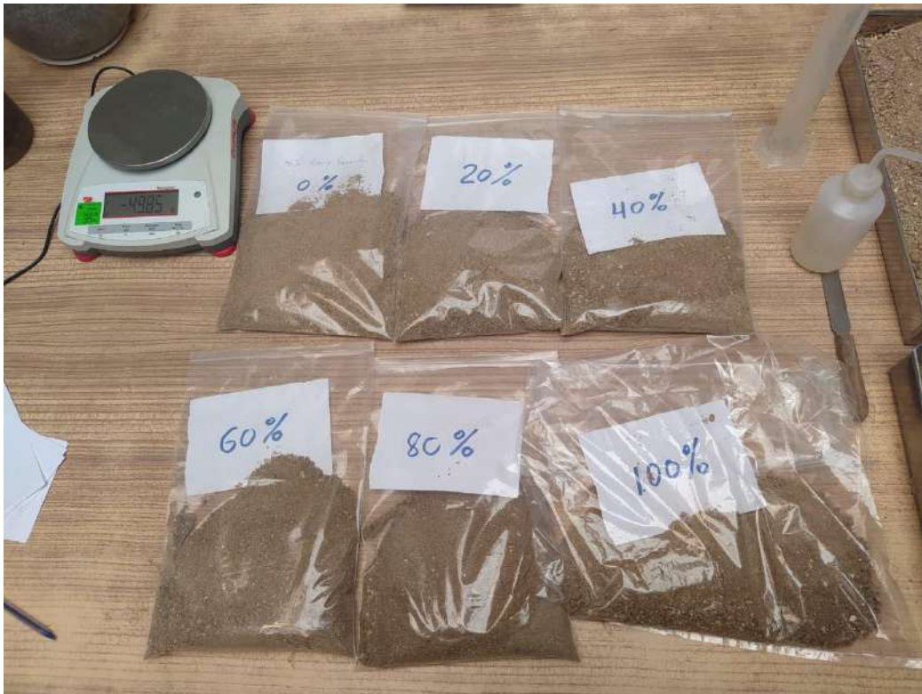
Fotografía 13: Muestras para ejecución de ensayos de corte directo. Material pasante la malla N°4 con porcentajes de aporte granular del 0%, 20%, 40%, 60%, 80% y 100%
