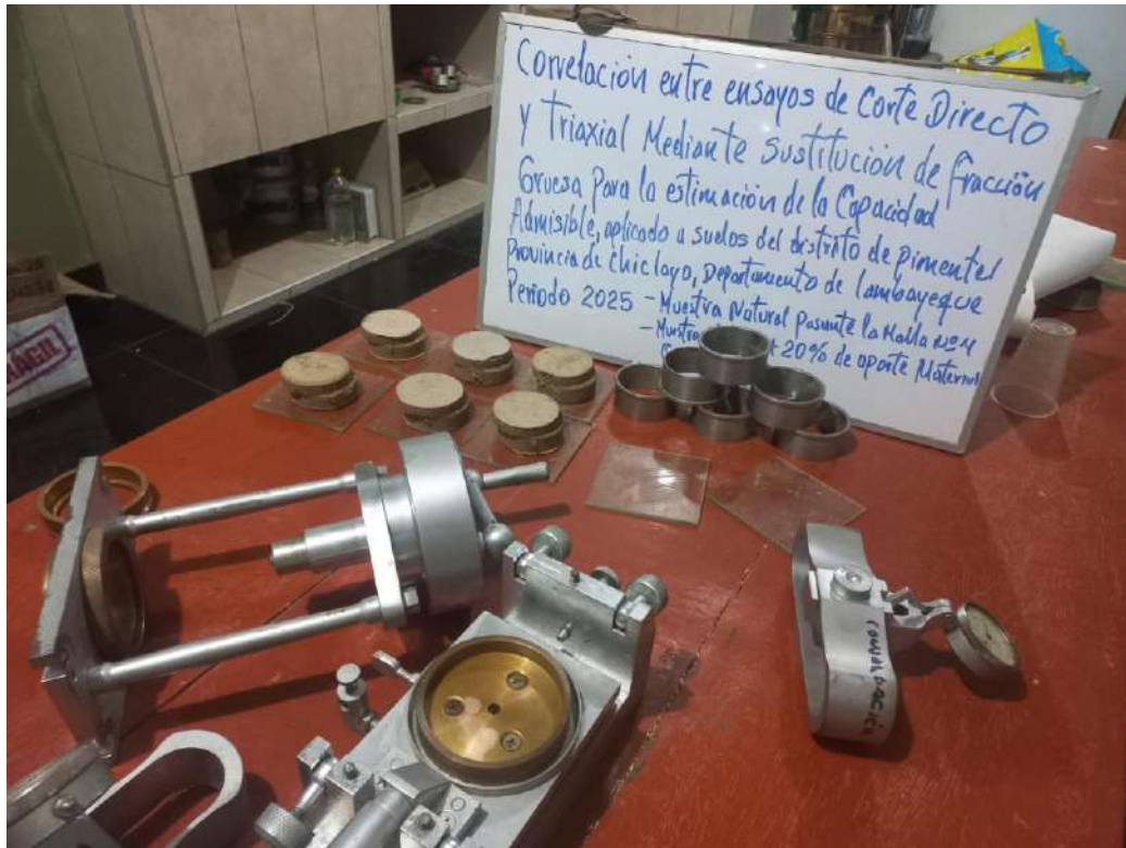
Fotografía 19: Muestran ensayadas bajo carga normal y tangencial al 0% y 20% de porcentaje de sustitución de fracción gruesa por arena.
