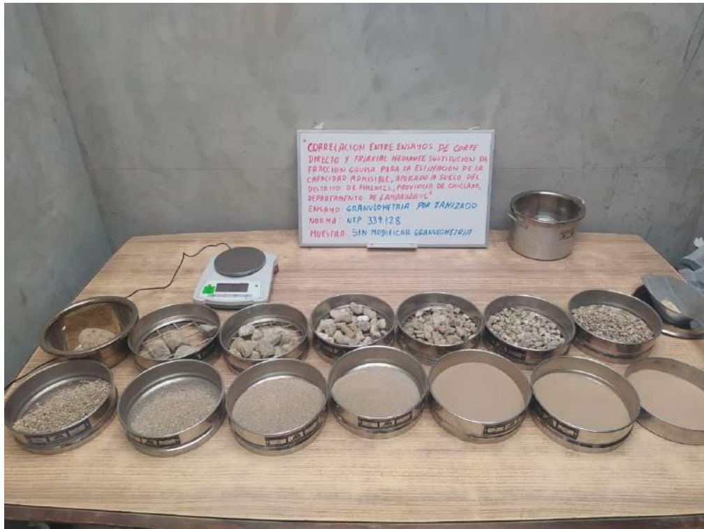
Fotografía 05: Ensayo de granulometría por tamizado de la muestra sin alteración de granulometría. Se visualiza la distribución de partículas, mostrándose visualmente el contenido de grava en la fila superior de tamices.
